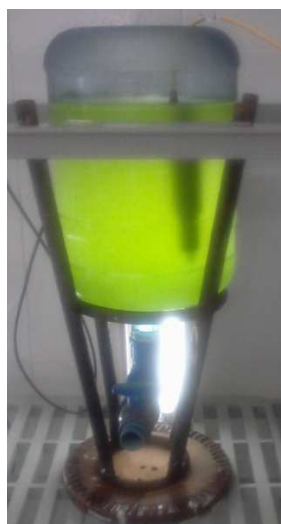
Figura 4: Recipiente cónico, construido para realizar la floculación
