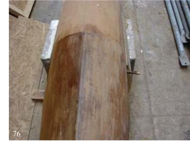
El casco luego de la aplicación del removedor y el respectivo raspado de la superficie.
