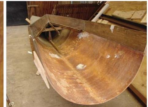
67. Parte delantera (proa) lista para la aplicación del adhesivo.
