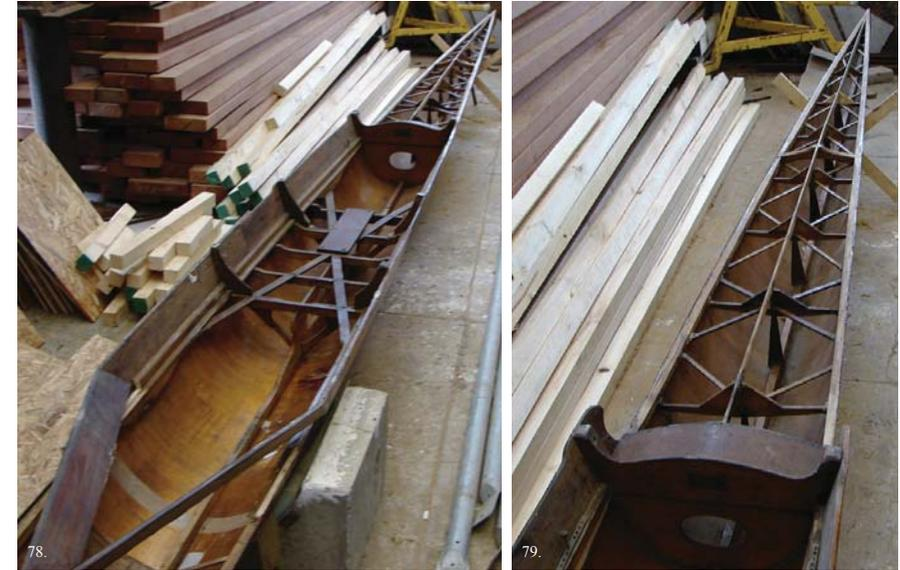
Al retirar la tela, aparece la estructura interior del bote, compuesta por elementos muy leves.
