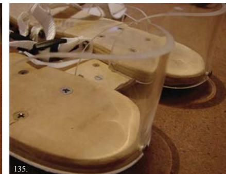
Segundo prototipo de taloneras, instalado en las nuevas pedalinas.
