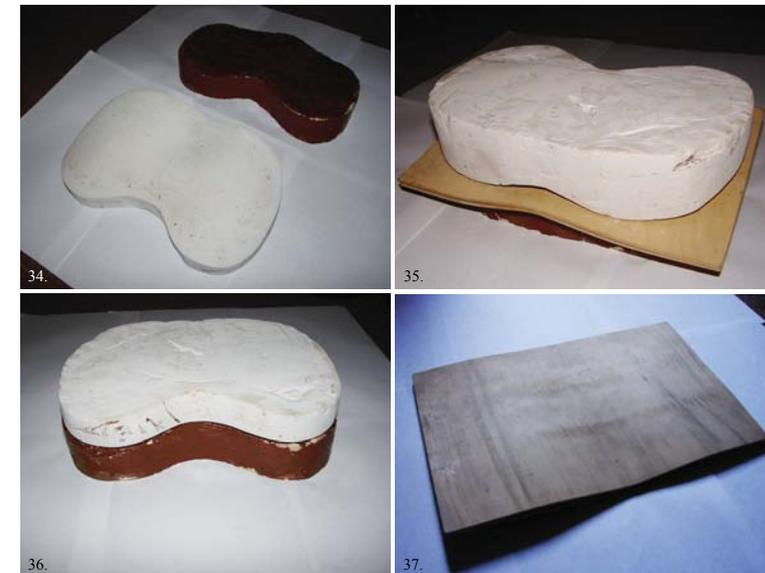
En las imágenes se muestra parte del proceso de moldeado del asiento del banco móvil, específicamente los elementos de moldaje y la pieza obtenida del proceso de moldeado.
