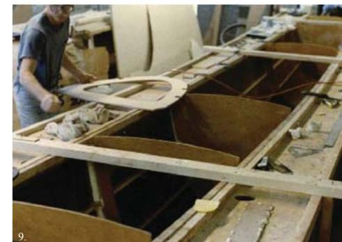
9. Construcción de una embarcación con la ayuda de un jig.
