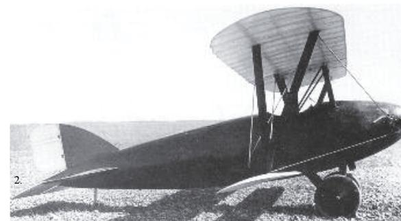
Izquierda- Loughhead S-1, diseñado por Jack Northrop. El fuselaje fue construido de madera contrachapada moldeada.
