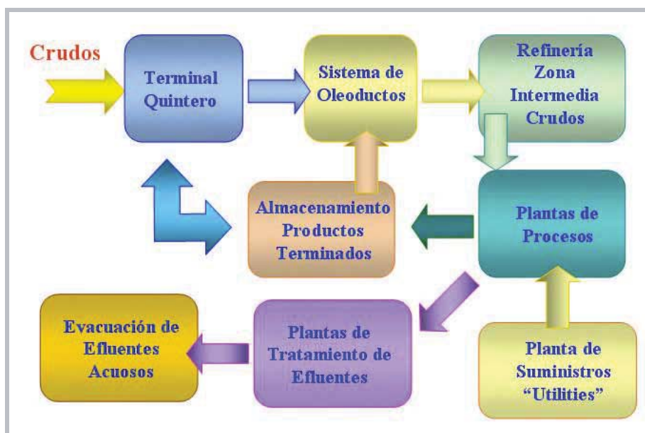
Figura 2.6: Esquema del proceso de Refinación
