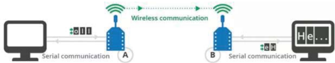
Figura 3-5 Tipos de comunicación de módulos XBee (fuente: www.digi.com)
