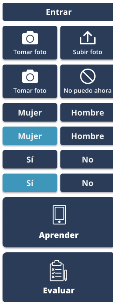
Fig. 54. Botones de acción. Ancho de 335px, alto variable de 55px, 100px o 150px. Textos en Open Sans Bold de 24pts. Botones dobles tienen 9px de separación entre ellos.
