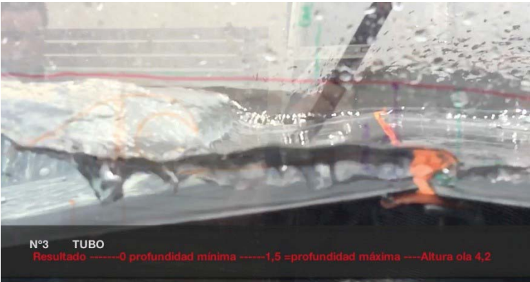
Fig. n 149: Prueba n°3 sin obstáculo; menor profundidad que la n°1 y n°2, con la misma pendiente se genera una rompiente tipo tubo, o Voluta de menor altura (hb), pero casi sin nivel de agua. Fuente: imagen propia.
