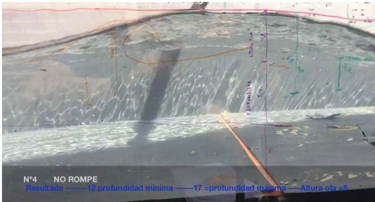
Fig. n 151: Prueba n° 4 sin obstáculo, esta tiene un mayor nivel de agua, y la ola pasa de largo, sin rotura. Fuente: imagen propia.
