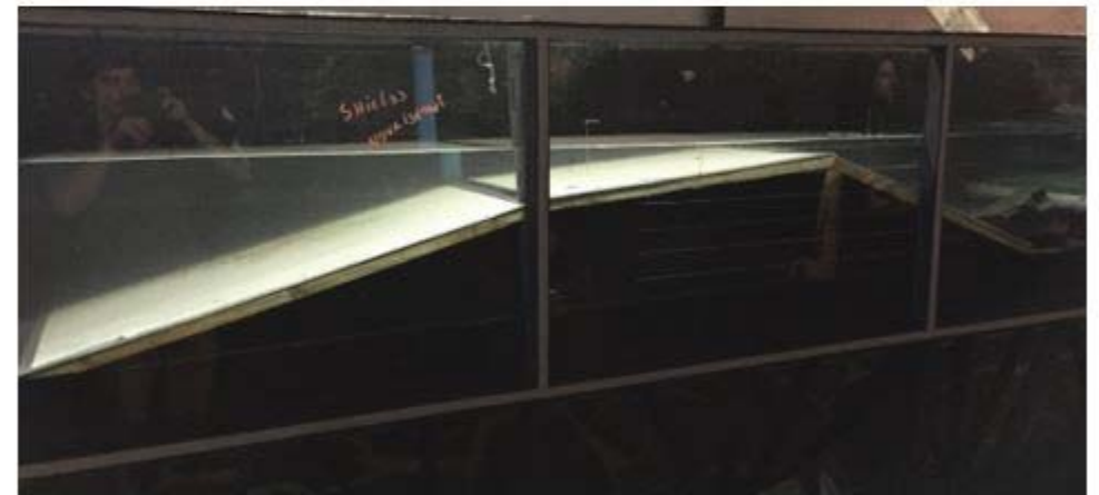
Fig. n 180: Rompeolas sumergido, construido en base a perfiles metálicos, con un revestimiento metálico remachado. Fuente propia
