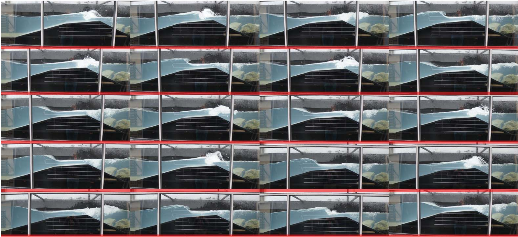
Fig. n 210: Secuencia de imágenes rompiente tipo voluta, Vista lateral canal de Olas. Elaboración propia
