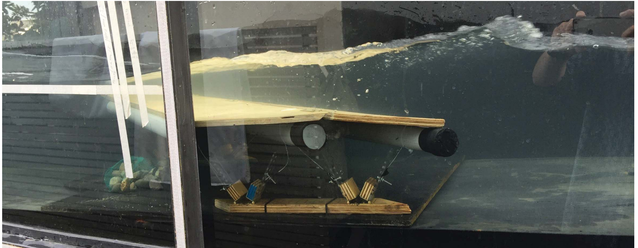
Fig. n 174: sistema flotante en base a tubos de PVC. con plataforma.
