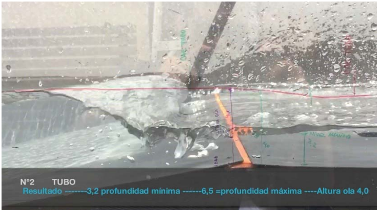
Fig. n 150: Prueba n°2 sin obstáculo; menor profundidad a la prueba n°1, con la misma pendiente pero menos agua genera una rompiente tubo o Voluta de menor tamaño o altura(hb). Fuente: imagen propia.
