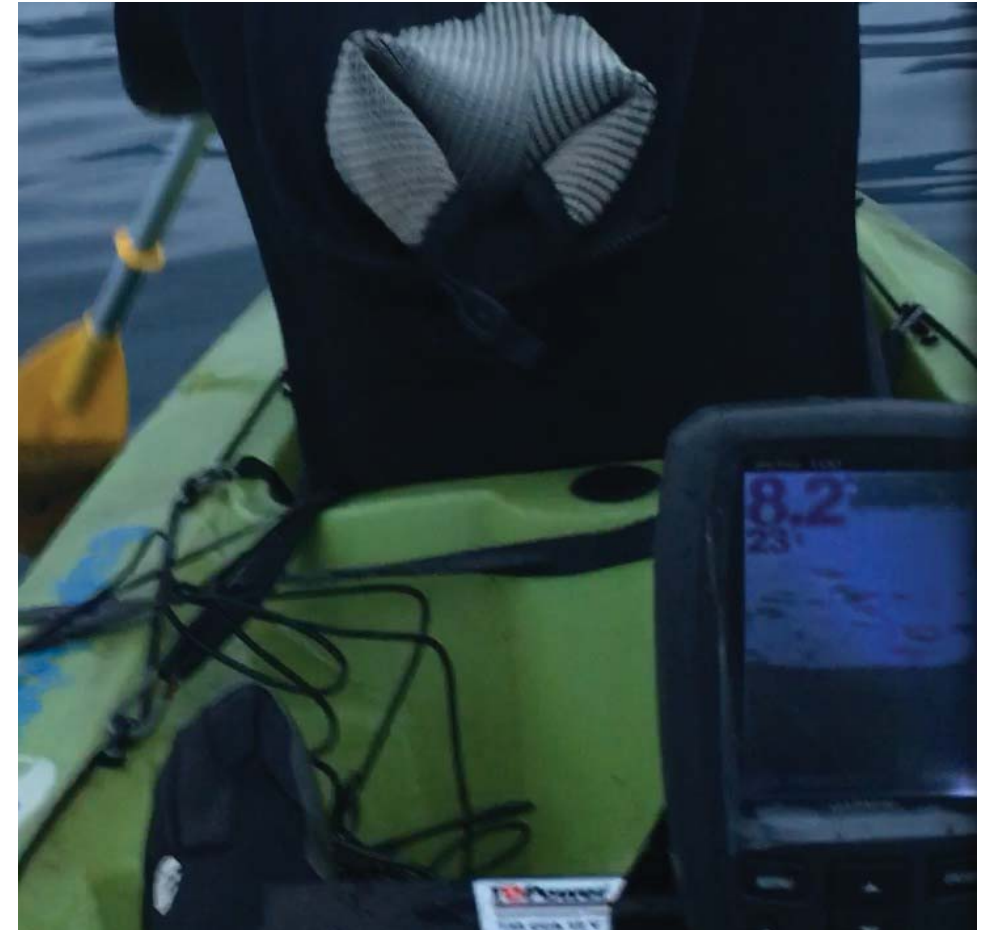
Fig. n 142: Vista del kayak tomando las mediciones en Pozo Luna Eco sonda marca d= 8,2 m. (d=profundidad). Fuente: propia
