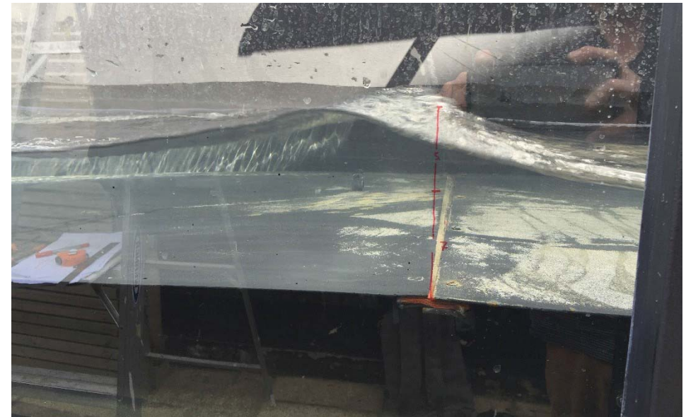
Fig. n 147: Canal de Olas en funcionamiento, M N&M, PUCV. Fuente: imagen propia.
