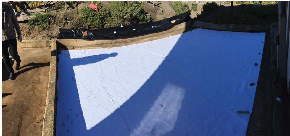
Fig. n 184: Plano de cotas instalado en modelo marítimo, el plano general se compone por 8 cintas de planos de 90 cm de ancho x 4 metros de largo. Fuente propia.
