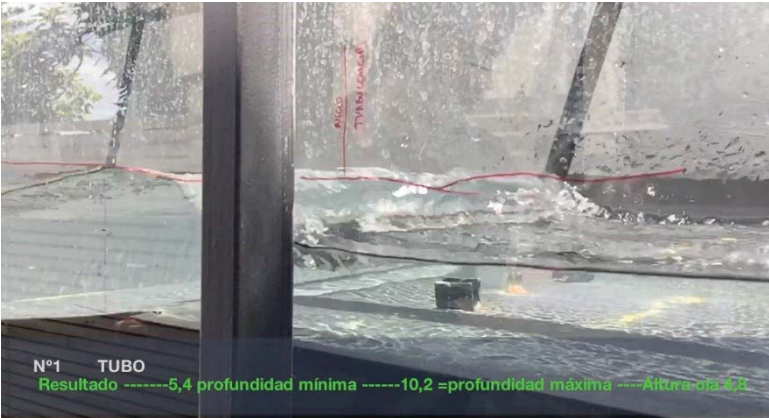
Fig. n 148: Prueba n°1 sin obstáculo; Canal de Olas con la pendiente del fondo y el canal en funcionamiento genera una rompiente tipo Tubo, o Voluta. Fuente: imagen propia.
