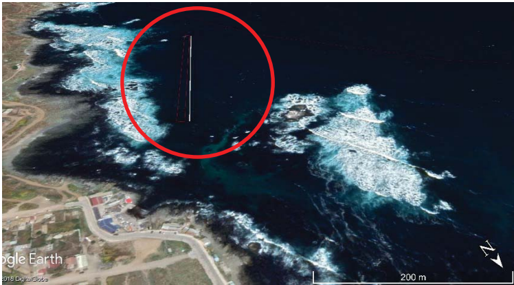
Fig. n 226: Resultado: Superposición de rompeolas en imagen Google Earth. Fuente :Elaboración propia.
