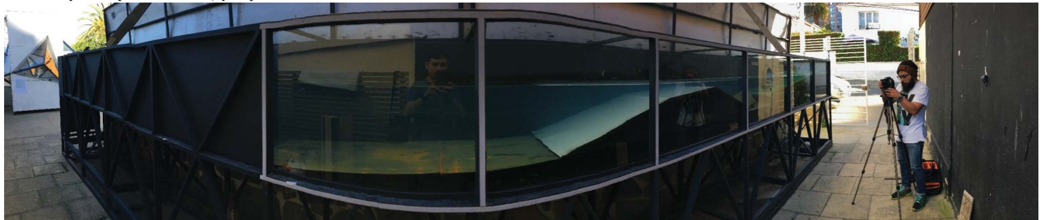
Fig. n 197: Panorámica canal de Ola con Rompeolas Pendiente Iribarren. Fuente propia
