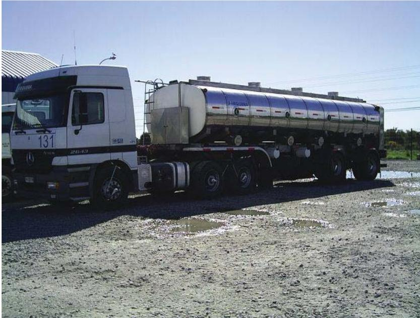
Figura N°3: Camión Rampla de acero inoxidable de cuatro estanques.
