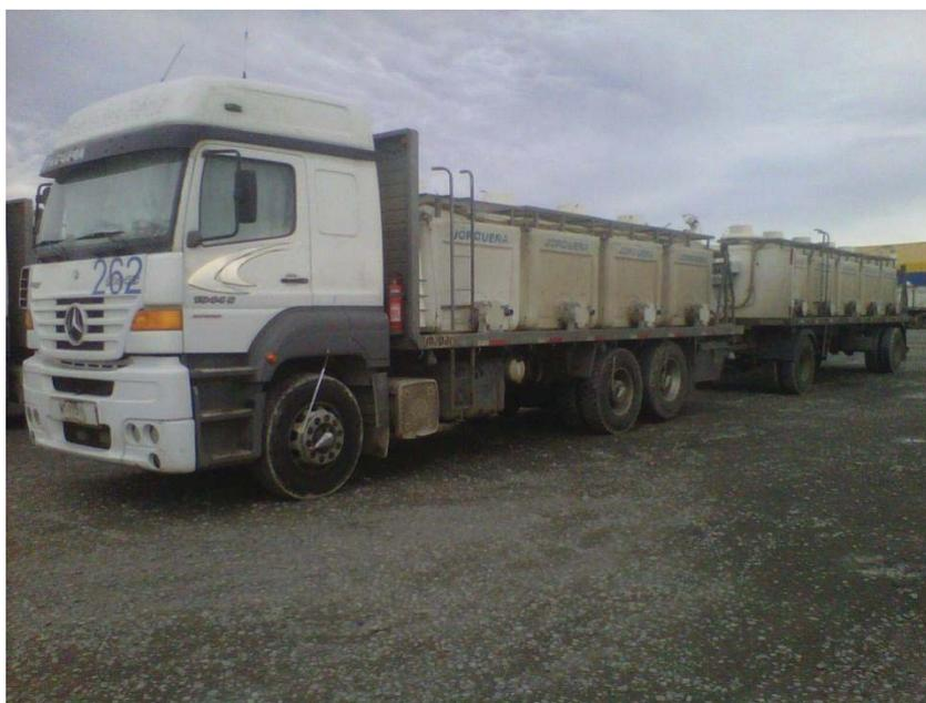
Figura N°2: Camión con carro con nueve estanques de plástico reforzado.
