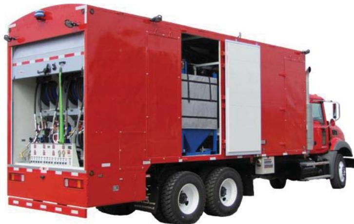
**Fig. 3 : "Camión tipo lubricador techado y con puertas abatibles"**
