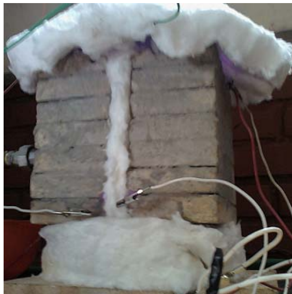
Figura 4.2: Reactor aislado completamente.
