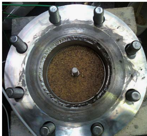
Figura 4.5: Reactor cargado de cáscaras de nueces (vista superior).
