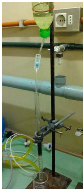
Figura 4.10: Columna de adsorción y sistema de goteo montados.
