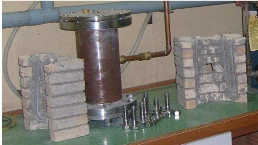
Figura 3.5: Cuerpos calefactores situados a ambos lados del reactor.
