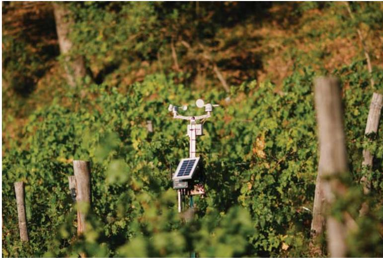
fig 83. Sensores climáticos instalados en la viña. Eran 5 sensores a lo largo del terreno en total. Estos medían, radiación solar, dirección y velocidad de viento, humedad de la tierra y lluvia.
