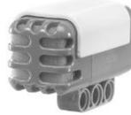
Figura 21 Sensor de Sonido [LegoImag, 2001]
