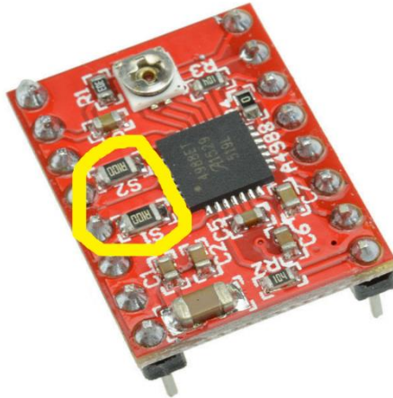
Figura 4-2: Driver A4988 con Resistencias de sensibilidad destacadas [22].
