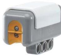
Figura 2. 17 Sensor de luz LEGO [Edubrick, 2006]
