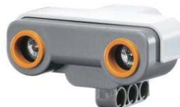
Figura 2. 18 Sensor ultrasónico LEGO [Edubrick, 2006]
