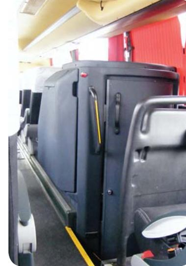
**Figura 38.** Cabina de baño interior, el exterior es el soporte y guardado. Fuente: Mauricio Bravo H.
