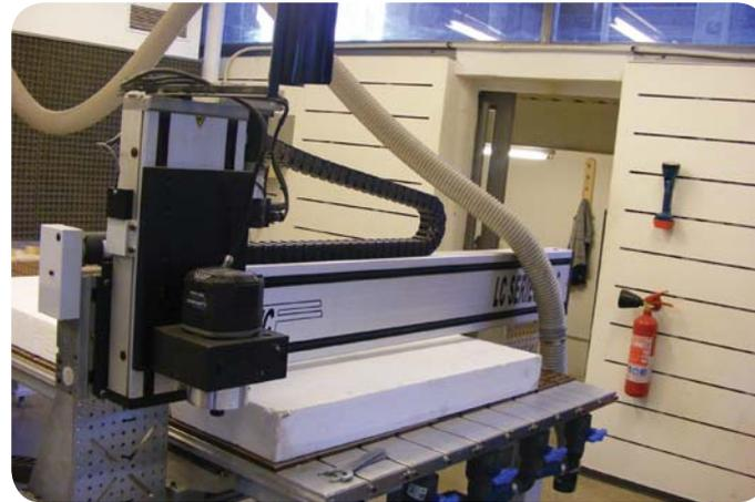
figura 186. Router CNC , con poliestileno de 100 mm de espesor
