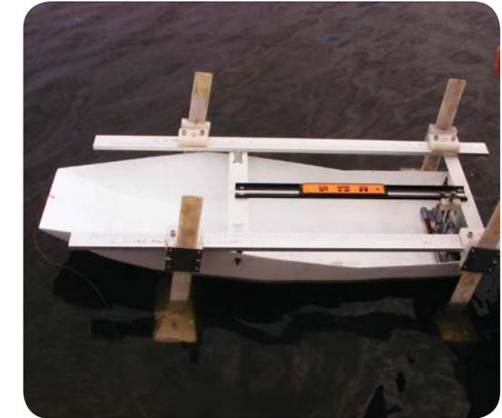
Figura 127. Nivelación respecto a su flotabilidad y lastre. Pevio a las pruebas. Fuente: M.Bravo
