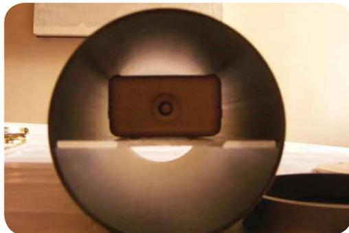
Figura 139. Tubo de PVC 100 mm diámetro con acrílico base.
