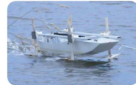
**Figura131.** Modelo arrastrado con 20 kg,el recorrido es encabuzado y discontinuo, no emerge. Fuente: registro videos B.Ivelic
