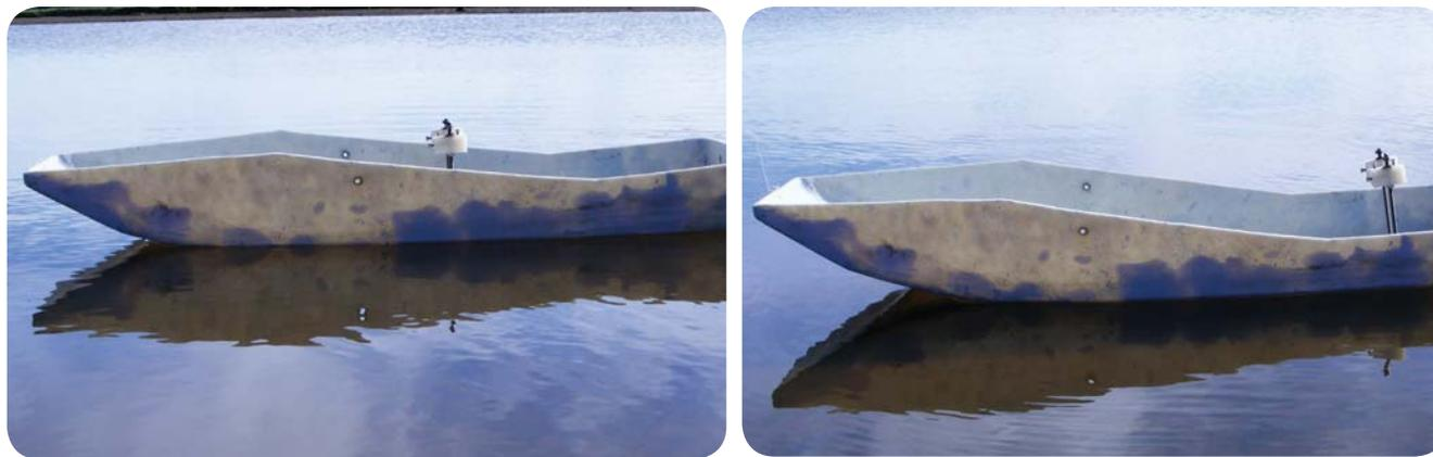
**Figura 118.** Pruebas al casco para posicionar lastre y encontrar su CG.
