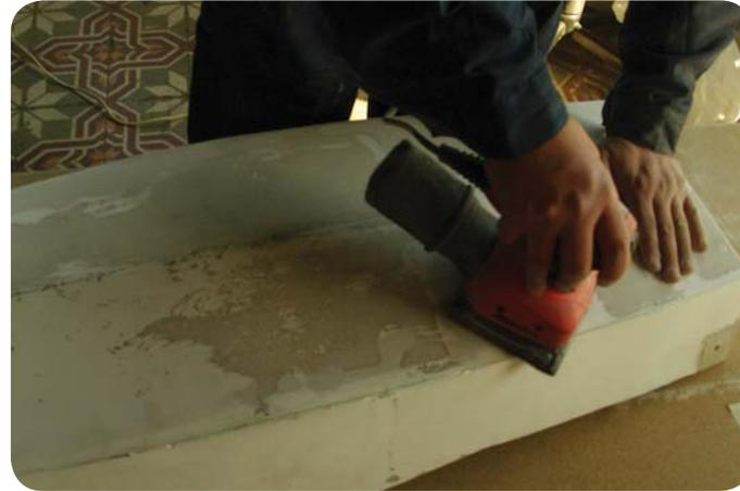
figura 178. Lijado del casco
