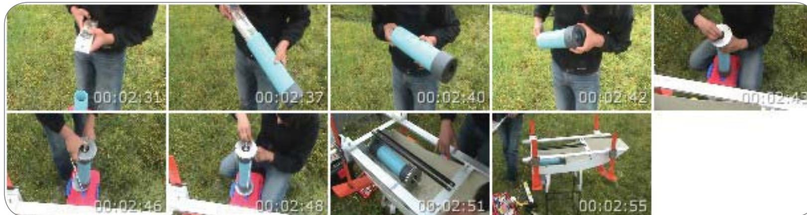
Figura 145. Secuencia de montaje de caja y dinamómetro en el modelo
