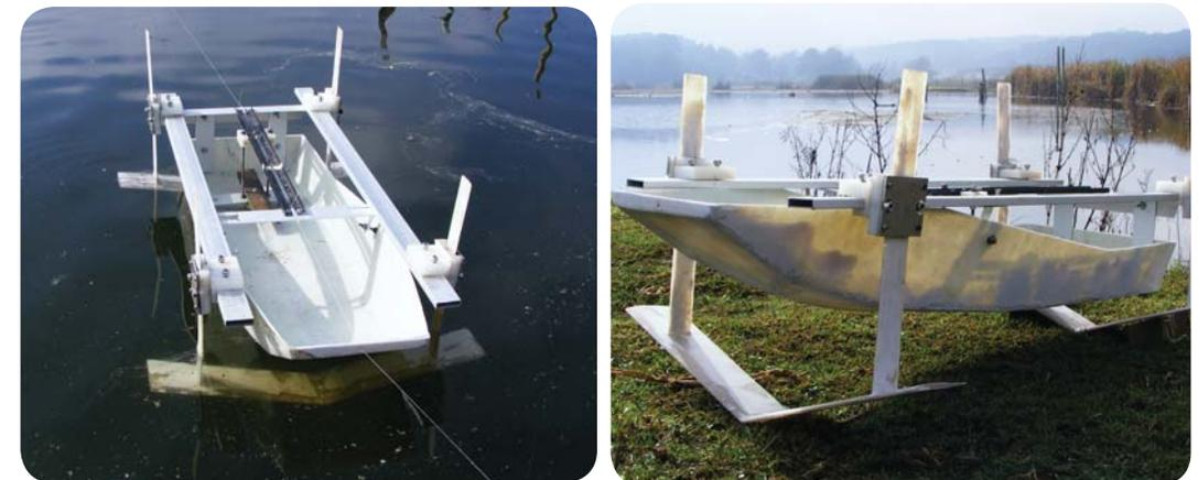
**Figura 115.** Modelo con peso ubicado y modelo fibra de vidrio para pruebas. Fuente: M.Bravo
