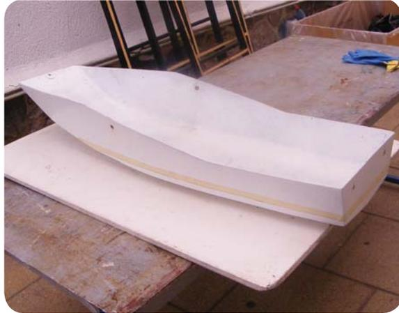
figura 181.Casco fibrade vidrio modelo escala 1:12
