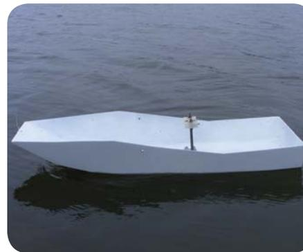
**Figura 123.** Casco con superficies tratadas y pruebas de flotabilidad. Comprobación del centro de gravedad.
