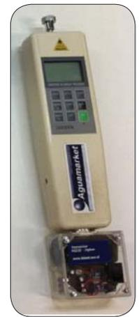
Figura 136. Dinamómetro utilizado en las pruebas
