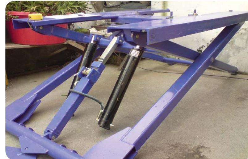
**Figura 75.** Elevador hidráulico del tipo tijeras Fuente: Tarco-Villavicencio, Diseño y construcción de un elevador electrohidráulico tipo tijera, Proyecto de grado-Escuela Politécnica del ejército, México 2010
