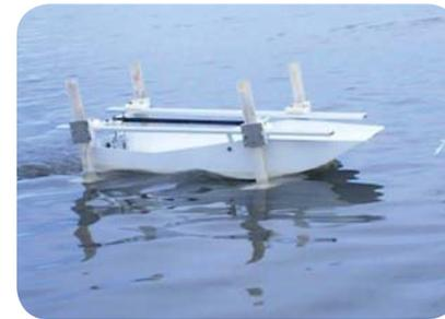
**Figura 130.** Modelo arrastrado con bajo peso, no emerge. Fuente: registro videos B.Ivelic
