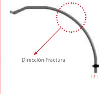
[3] En el esquema se representa la fuerza hecha por el equipaje en el punto medio de la zona de carga, se sugiere que el material usado para la construcción de esta zona sea de alta resistencia para que el colapso en este punto no ocurra durante el uso del remolque
