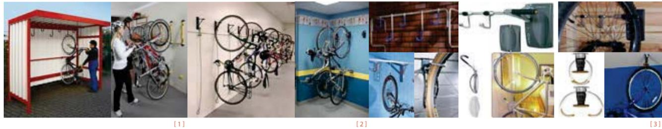
[1] La forma vertical de sujeción, es la posición más común de transportar o estacionar las bicicletas, y además una de las más sencillas. La integración de sujeción a la rueda trasera de las bicicletas impide el movimiento de estas, favoreciendo el transporte durante el movimiento del metro tren.
