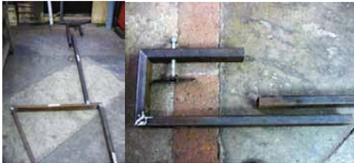
Estructura primaria, escuadras de fierro, que le dan forma al «muro curvo» y permite su «colgado y apriete» de las vigas superiores de cajón.
