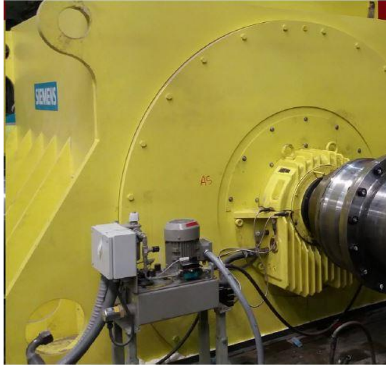
Figura 2-5: Sistema de levante, Jacking oil.
