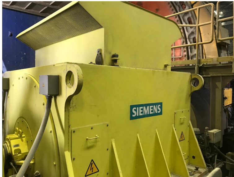
Figura 2-9: Motor síncrono rotor cilíndrico Siemens.
