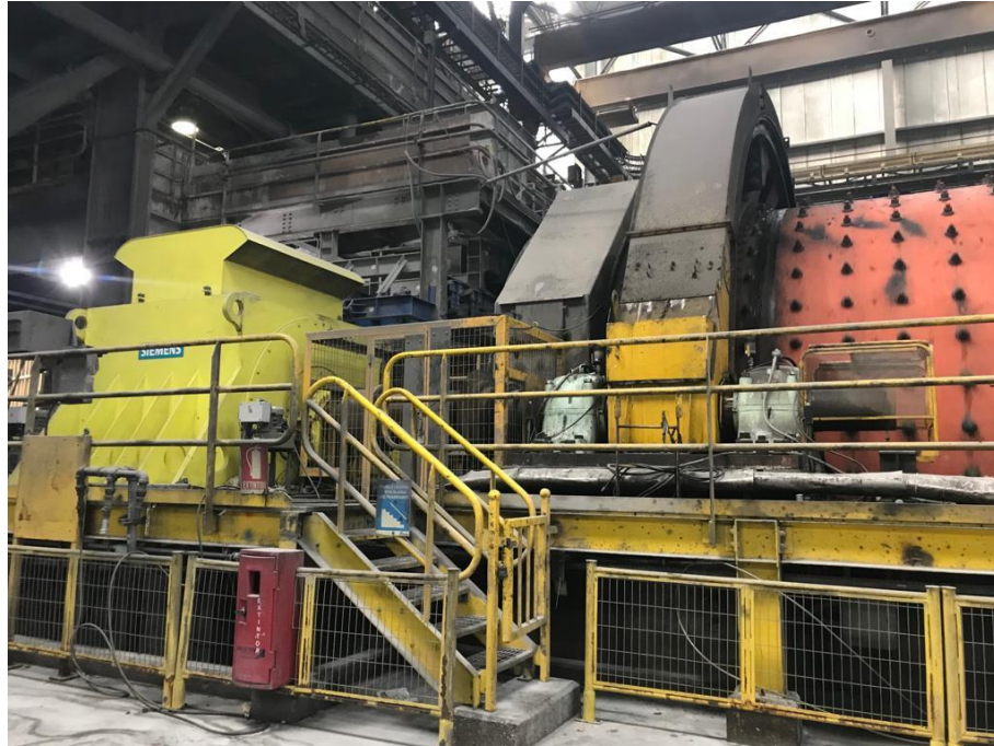
Figura 2-4: Vista lateral, motor, piñón, corona y molino, Compañía Minera Doña Inés de Collahuasi.
