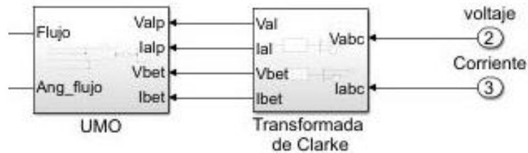
Figura 4-16: Subsistema Modelo de voltaje (UMO).
