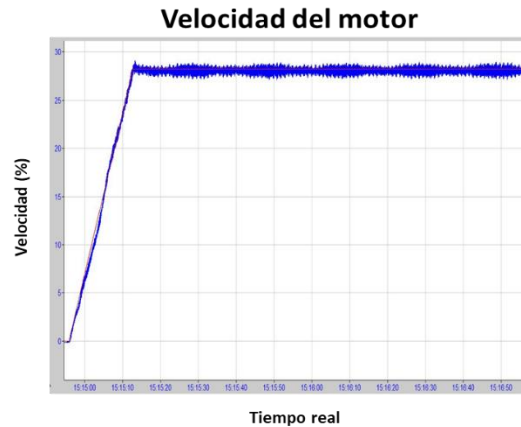
Figura 5-2: Velocidad del motor registrada, IBAnalyzer.
