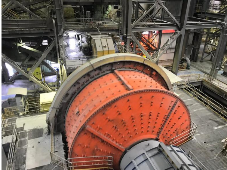
Figura 1-12: Molino SAG 1 accionado por doble piñón corona, Compañía Minera Doña Inés de Collahuasi.
