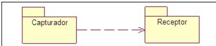
En la Ilustración 9-25, se puede apreciar los dos componentes principales de esta herramienta. El Capturador que se encontrará en el dispositivo móvil y el Receptor que se encontrará en el computador.
