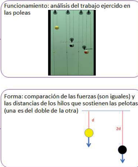
Figura 5.16 Funcionamiento y forma del uso Análisis del trabajo ejercido en las poleas.
