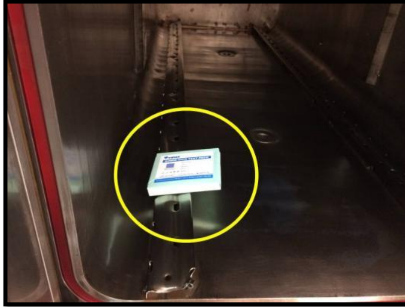
Figura 33: Test de Bowie & Dick al Interior Cámara Equipos Serie-1000
