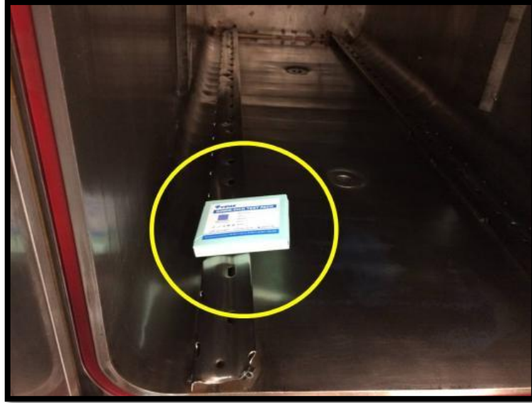
Figura 23: Test de Bowie & Dick al Interior Cámara Equipos Serie-1000
