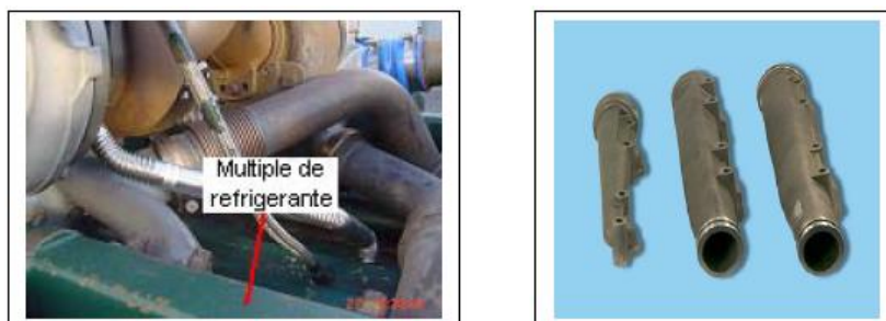
Figura 1.50: Múltiple de refrigerante
