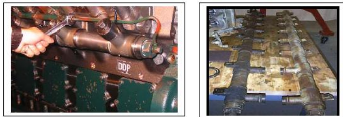
Figura 1.41: Galería del common rail
