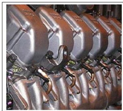
Figura 1.40: Tapas de válvulas
