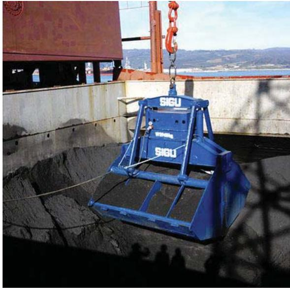
Figura N° 12: Pala granelera
