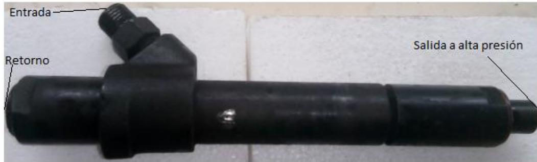
**Figura 31. Cuerpo del inyector.**
