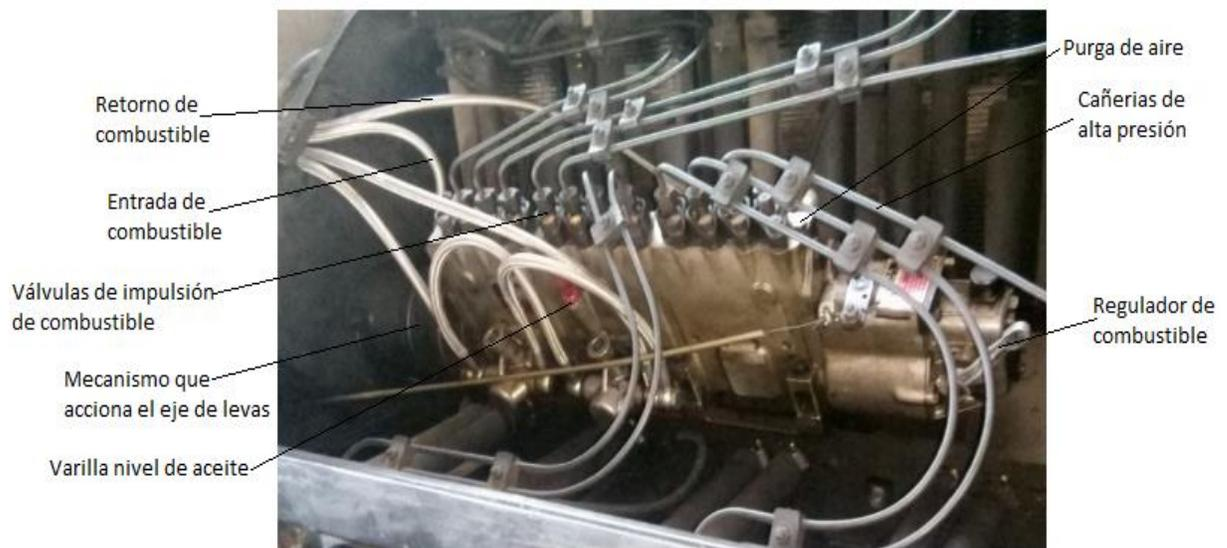
**Figura 7: Bomba inyectora S.I.G.M.A 12 cilindros con regulador S2.**
