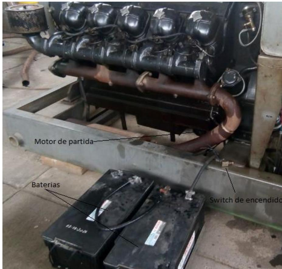
**Figura 21. Conexión directa de las baterías al motor de partida.**
