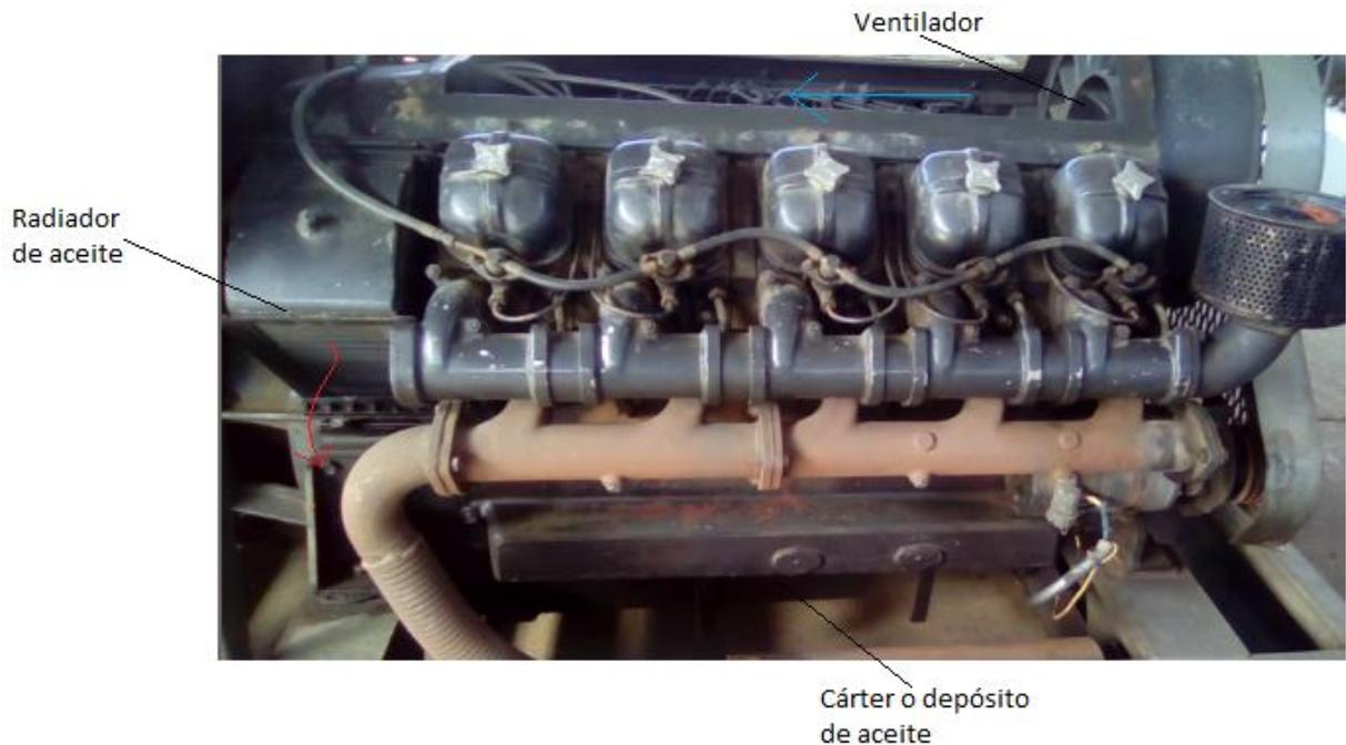
**Figura 5: Depósito de aceite y radiador de motor Alsthom Dieselair 120.**
