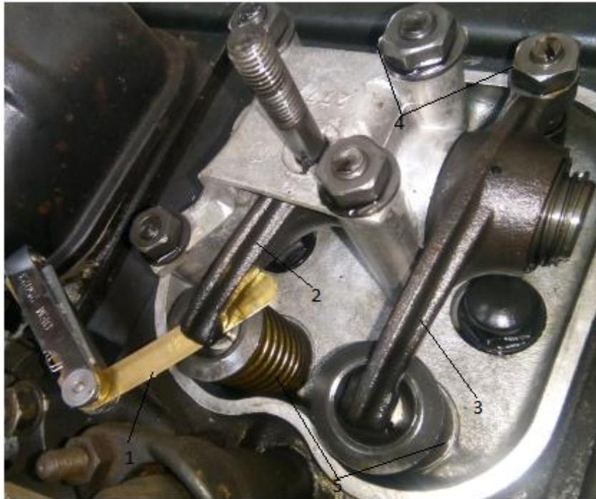
**Figura 35. 1, Galga de espesores. 2, Balancín de admisión. 3, Balancín de escape. 4, Tuercas para regulación de holgura. 5, Resorte de válvula.**
