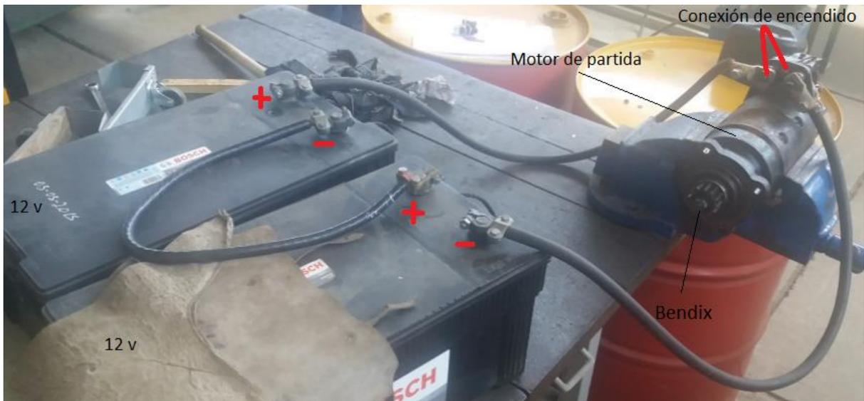
**Figura 20. Conexión de baterías al motor de partida.**
