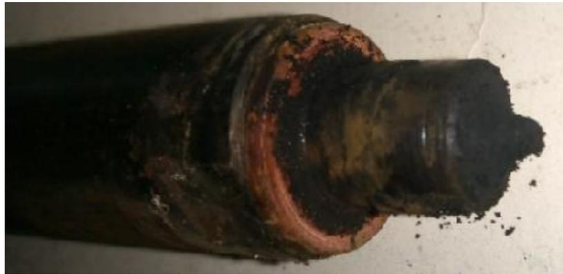
**Figura 30. Extremo del inyector de motor Alsthom Dieselair 120.**
