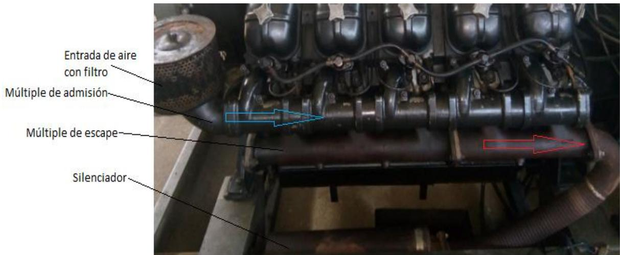
**Figura 9: Silenciador y múltiples de admisión y escape del motor Alsthom Dieselair 120.**
