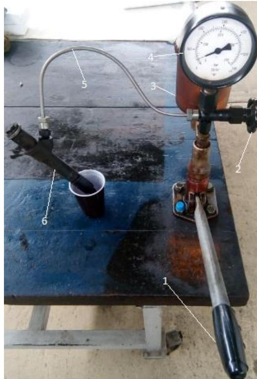
**Figura 32. 1, palanca manual de accionamiento de la bomba. 2, válvula de cierre. 3, depósito de combustible. 4, manómetro. 5, cañería. 6, inyector.**
