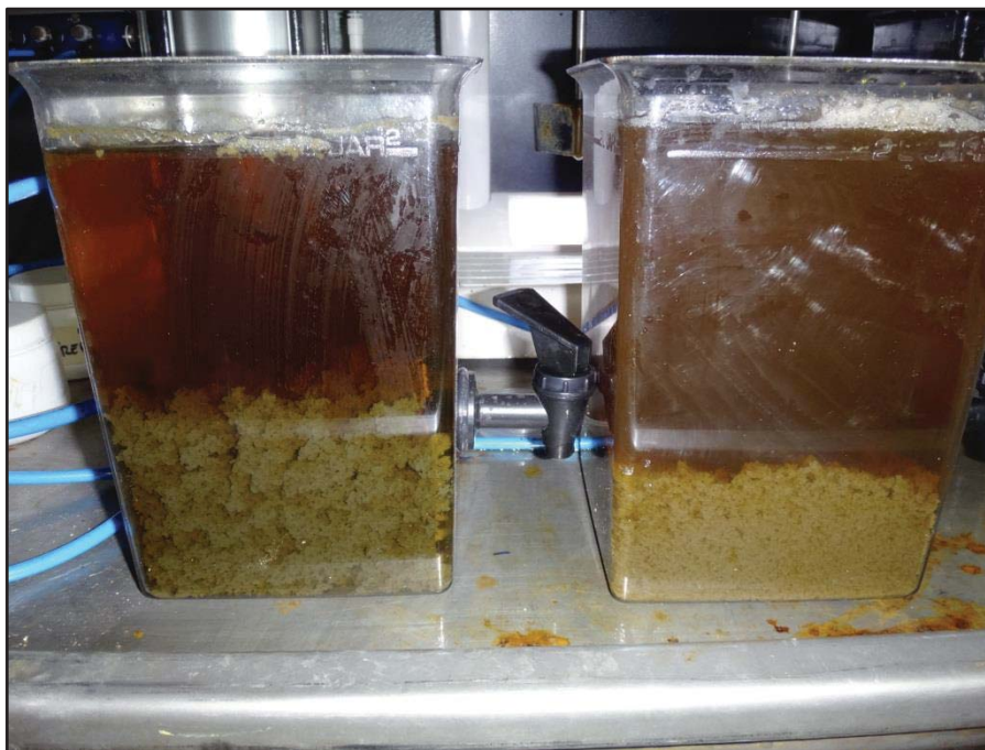
Figura 7. Resultados Test de Jarra con NaOH (izquierda) y Licor de Prensa (derecha).
