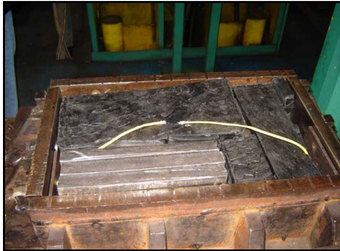
Imagen 4.7: Instalación de termopar en el molde
