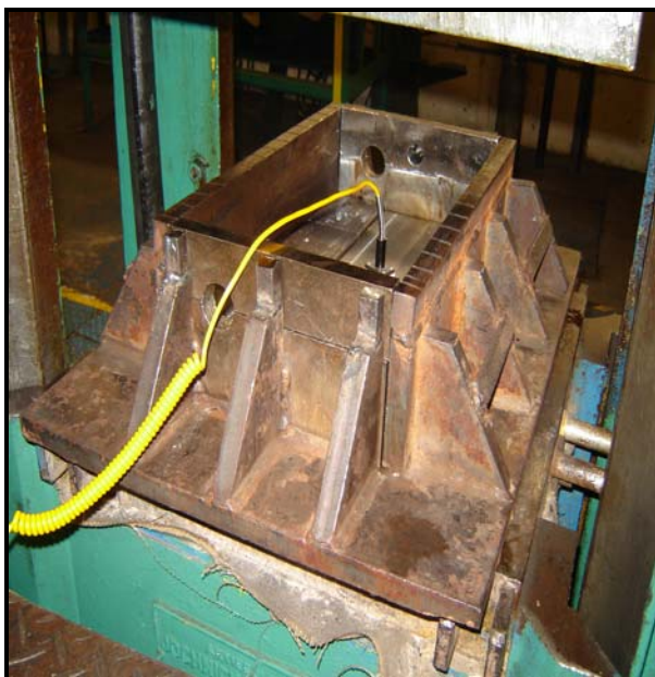
Imagen 4.5: Medición de temperatura del molde
