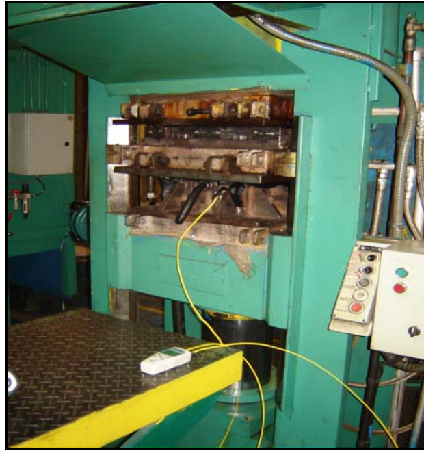
Imagen 4.8: Medición de temperaturas durante el proceso
