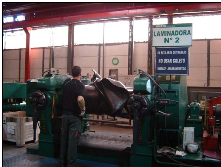
Imagen 2.2: Laminadora de caucho
