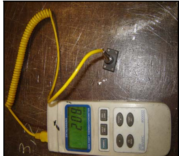
Imagen 4.4: Termocupla con sonda magnética
