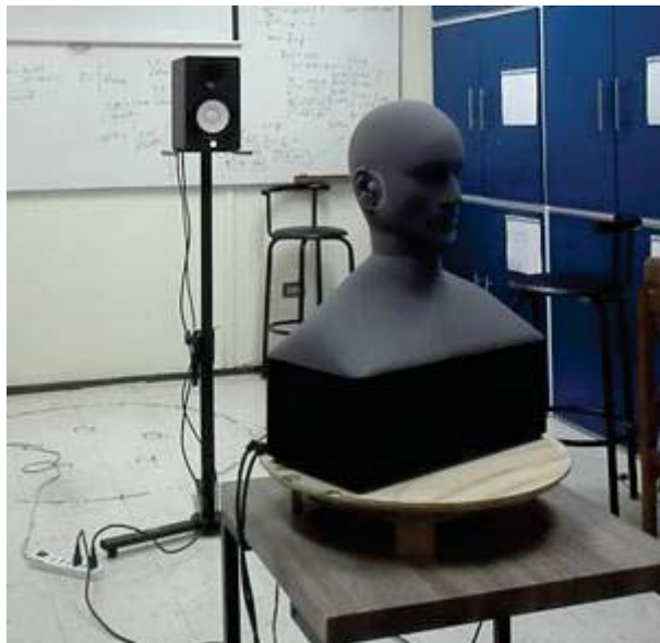
Figura 4-1: Medición de HRTF en el laboratorio de acústica y vibraciones de la Escuela de Ingeniería Eléctrica (EIE).
