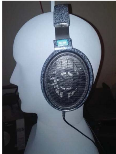
Figura 4-11: Proceso de medición de HpTF.
