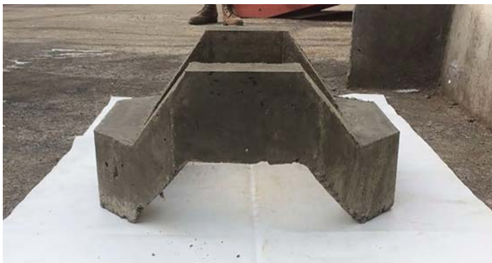
VISTAS DEL BLOQUE DESPUES DE DESMOLDAR
