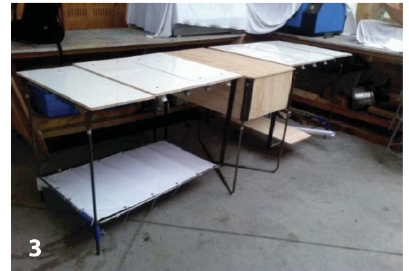
Fig1 y Fig 2.- Cubierta inferior construida a partir de tela PVC. Fig 3 - Cubierta inferior instalada en el módulo de cocina.
