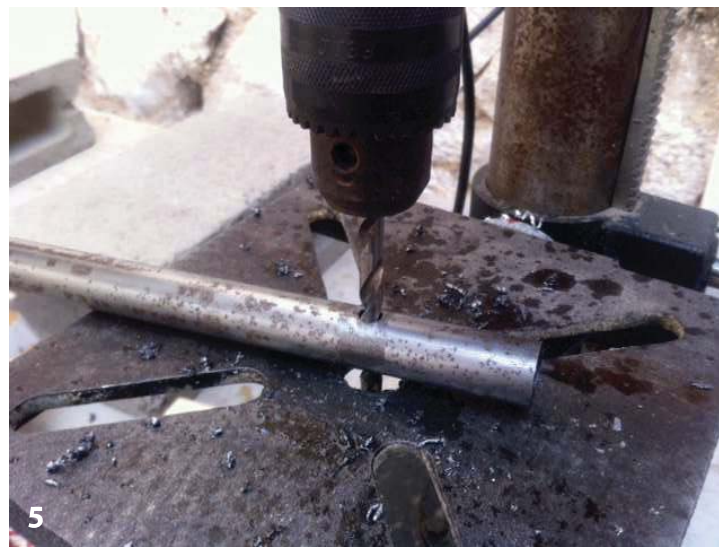
Fig 4.- Se curva la sección hasta dar con los 90° que se requieren. Fig 5.- Luego cada una de las 16 secciones se perforan 3 veces. Fig 6.- Sección tubular terminada.
