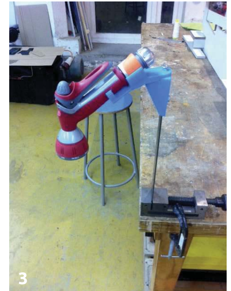
Fig1 y Fig 2.- En las imagenes se aprecia el proceso de impresión del soporte de la llave de agua, esta fue impresa en la impresora Makerbot a partir de PLA.
