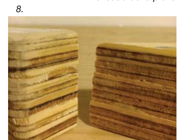
8. Se afirma como efectiva la aplicación del Vitrolux – 60 al exponerse dos piezas a una lluvia normal durante esta temporada, siendo el resultado el incremento del espesor de la pieza desprotegida por más de 3mm.
