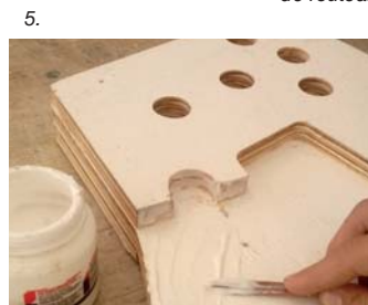
5. Encolado de sub piezas
