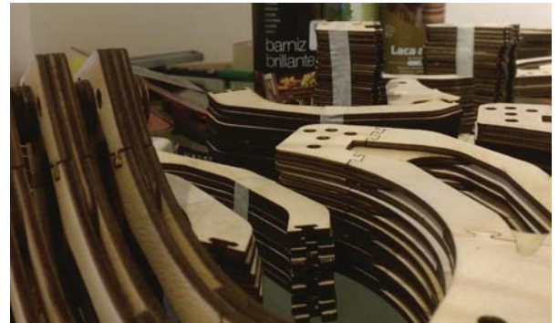
3. Después se arma cada pieza y se lijan para preparar el vitrificado.
