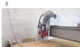
3. Frezado CNC de sub piezas. Acción de routear.
