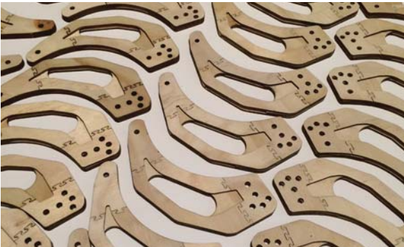
4. Las piezas de la maqueta una vez construidas son protegidas con Laca Acrílica, para las 90 piezas, 3 capas por ambos lados se utilizaron 520grs.
