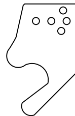
Piezas que cambiaron sustancialmente en la prueba dos fueron las almas, que aumentaron su rango de agarre.
