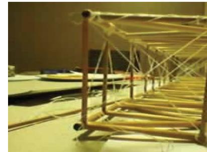
imagen de viga en proceso de elaboración. Se considera palos de maqueta e hilo para tensar
