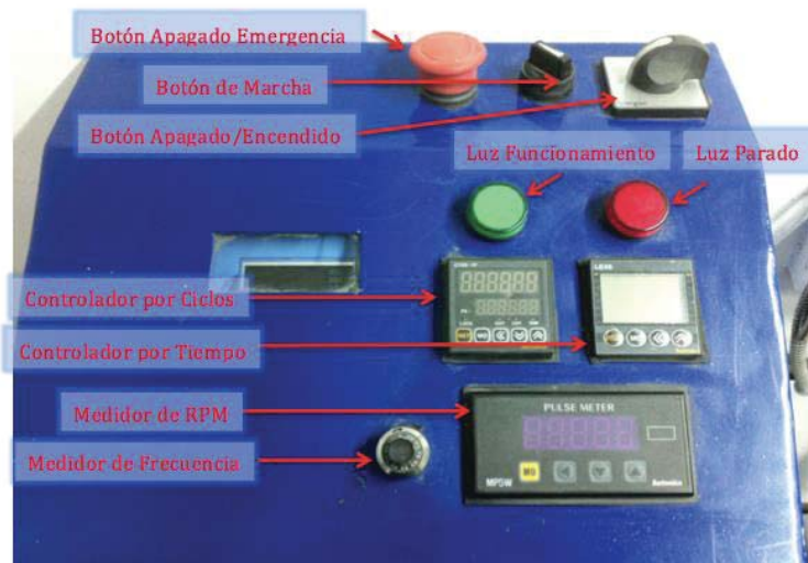
Figura C-1: Tablero del molino Starkey
