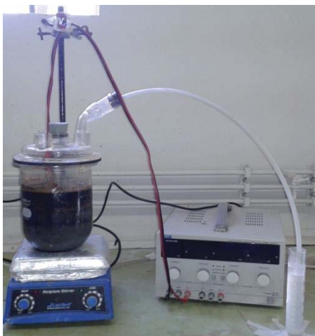
Figura 17. Aplicación del proceso Electro-Fenton a la mezcla de riles
