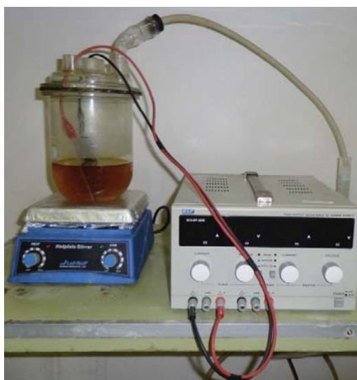
Figura 28. Conexión del reactor con la fuente de poder
