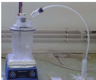
Figura 14. Conexión del reactor hacia la trampa de gases
