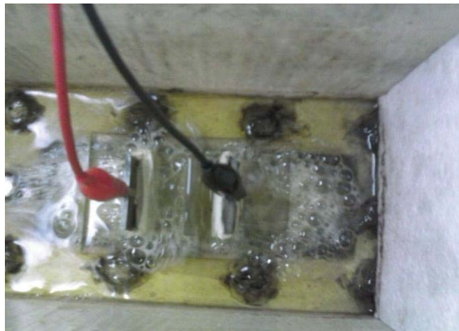
Figura 8. Placas instaladas en la parte superior del reactor
