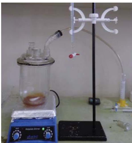
Figura 22. Conexión del reactor hacia la trampa de gases
