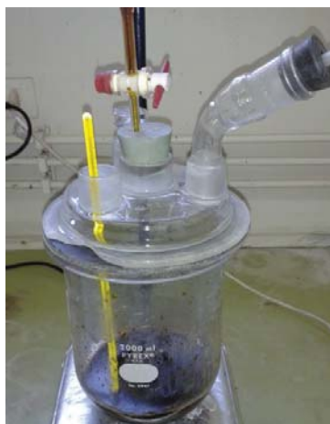
Figura 15. Mezcla de los riles orgánicos con los riles que contienen metales pesados
