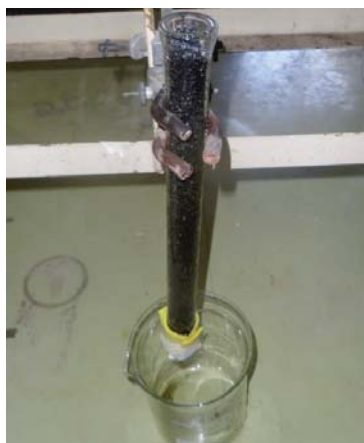
Figura 31. Proceso de adsorción con carbón activo
