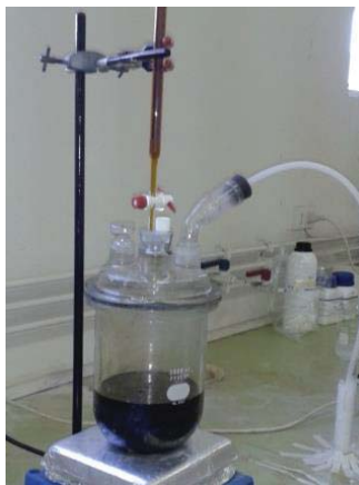
Figura 16. Riles ácidos son agregados al reactor
