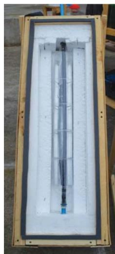
Colector aislado sin cubierta
