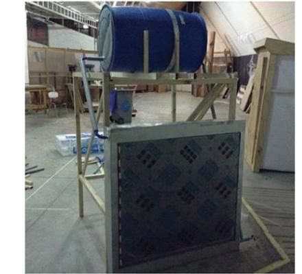
Vistas de la estructura con estanque y colector montados
