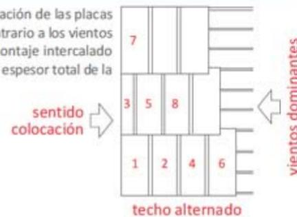
2. Fijar en todas las ondas el borde de punta en la saliente y luego 2 filas intermedias
