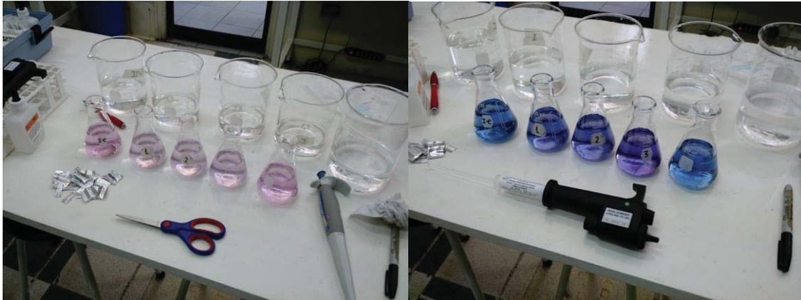
Fig. 6. Medición por colorimetría de calcio total.
