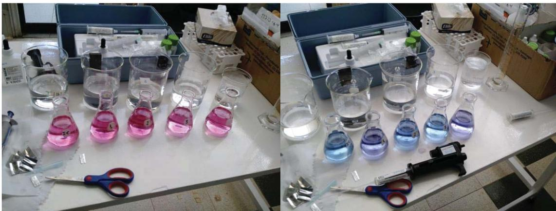
Fig. 5. Medición por colorimetría de dureza total
