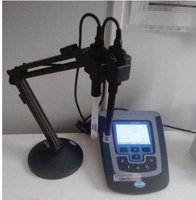
Fig. 4. Medidor multiparamétrico con sonda para medición de sodio.
