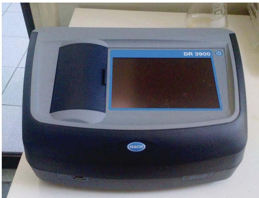
Fig. 7. Espectrofotómetro DR-3900
