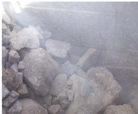
Figura 4.2: Acumulación de material en chancador primario
