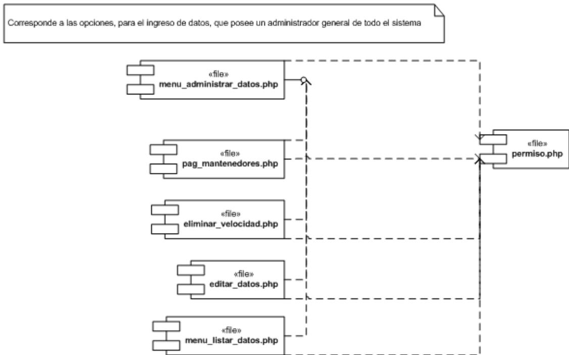
Figura 4.92 Diagrama de Componentes sección “Mantenedores”, segmento “Administrar Datos” como AG.
