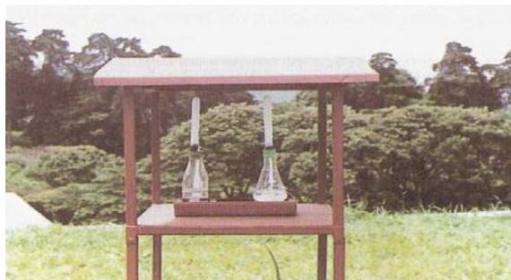
Figura 2.12 Dispositivos para determinar cloruros.
