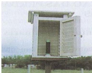
Figura 2.11 Dispositivo para determinar sulfatos.
