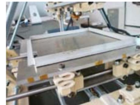
Se factura una estructura de aluminio para alinear la cama caliente con el extrusor, y así equilibrar los ejes.
