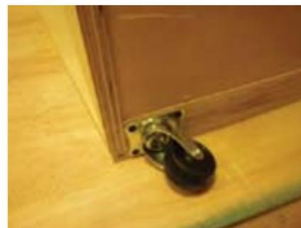
Se ponen las 4 ruedas atornillando tornillos para madera en 3 de los 4 orificios, en el cuarto horificio, se le cruza un perno para asegurarse de que jamás se podrá salir la rueda.
