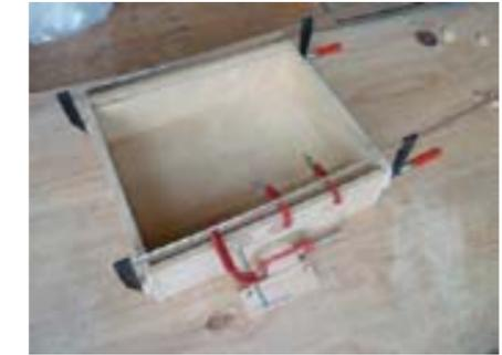
Si es que se necesita prensar áreas grandes, y no se tienen sargentos del tamaño adecuado, se puede utilizar el sistema de la cuña.
