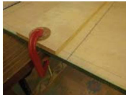
Cortar los detalles de las partes que se necesiten. Al cortar de caladora, se utiliza otro trozo de madera como línea guía, así uno se asegura de que el corte resultará bien.
