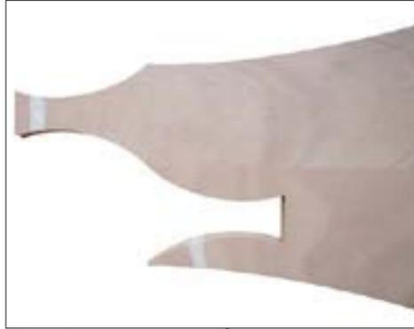
Si existe margen de error en éste proceso, éste tiene que ver con el traspaso de los planos CAD a la máquina, dónde muchas veces las curvas se distorsionan al hacer los cambios de formato.
