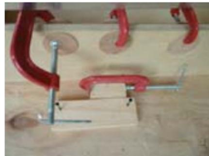
El sistema de la cuña consiste en poner un tope a ambos lados, atornillado al suelo, y a uno de los dos lados poner dos triángulos en forma de cuña. Luego apretar los dos triángulos con una prensa.
