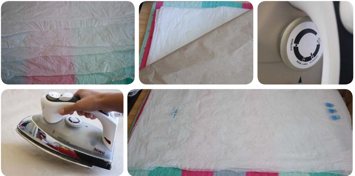
Termofusión de cantos superpuestos de dos láminas de plástico biodegradable pre-fusionadas con calor
