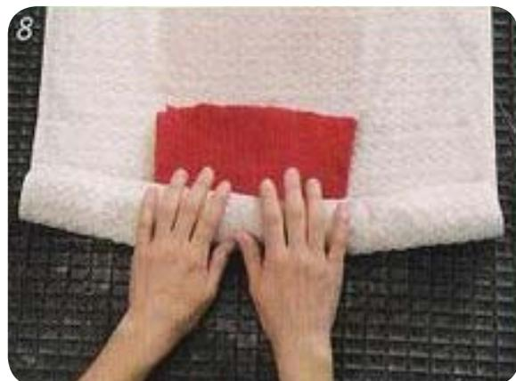
Proceso de producción de prototipo térmico en fieltro sobre molde.
