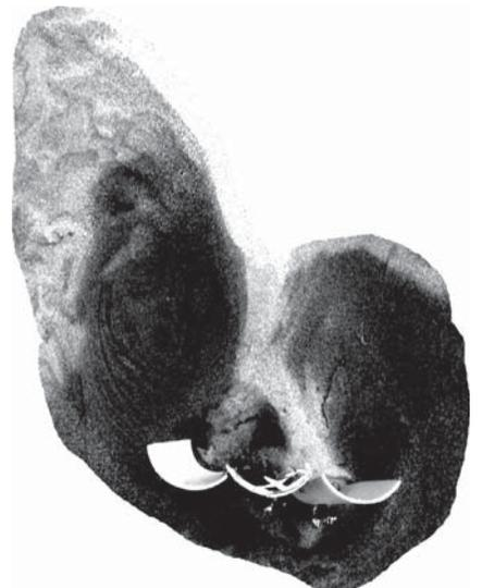
Expansión del socavamiento a manera de elipses, con viento golpeando en la cara convexa del objeto.
