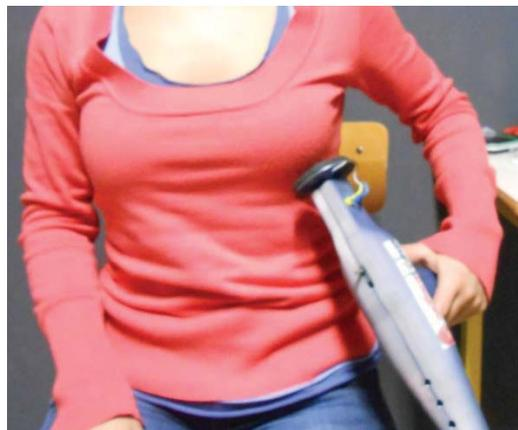
**Fig. 29: Posición Indentor medición por debajo**
