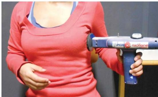
**Fig. 28: Posición Indentor medición lateral**
