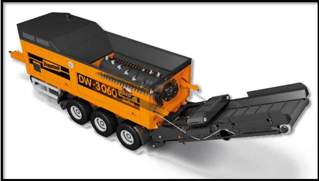
Figura 3.8: trituradora de basura de un eje.
