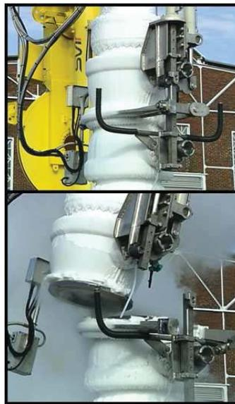
**Fig.5: Muestra de activación de sistema PERC en frío (Fuente: Manual SVT)**
