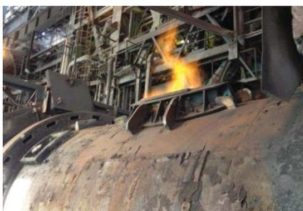
**Figura N° 70: Boca de carga horno.**
