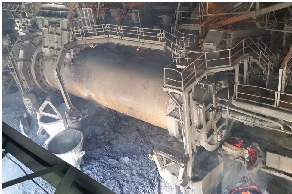
**Figura N° 7: Convertidor Teniente, Fundición Caletones.**
