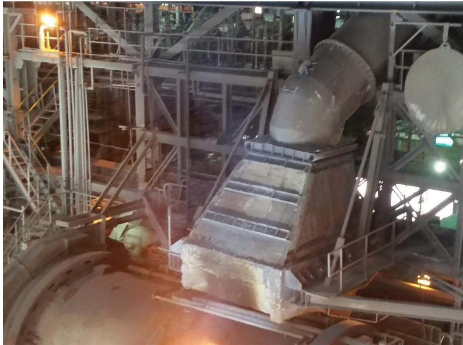
**Figura N° 21: Campana captación gases.**
