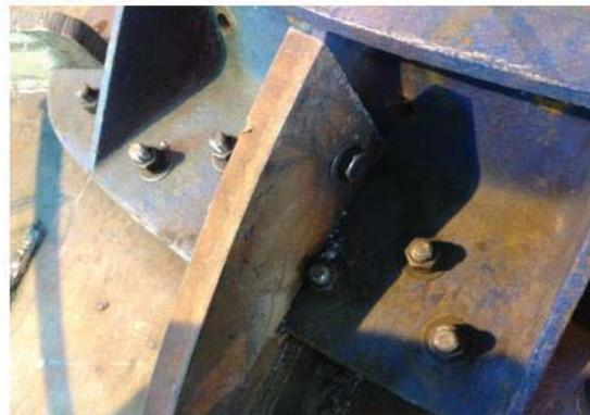
**Figura N° 59: Perros boca de carga.**
