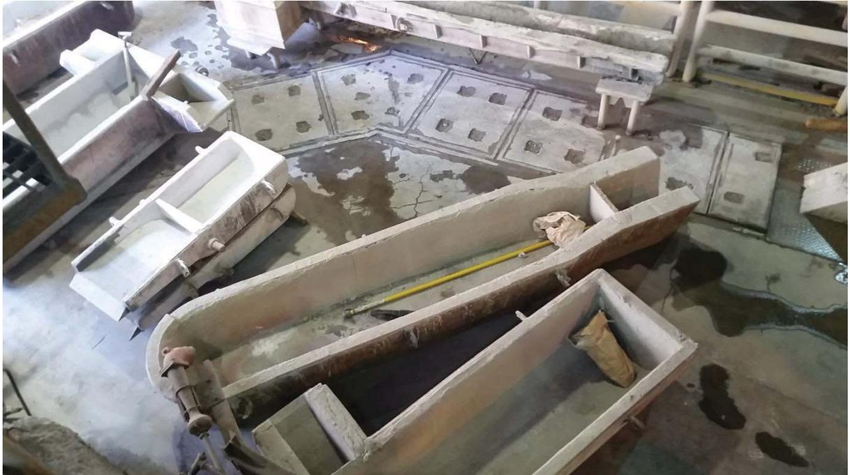
**Figura N° 27: Canales de Moldeo.**
