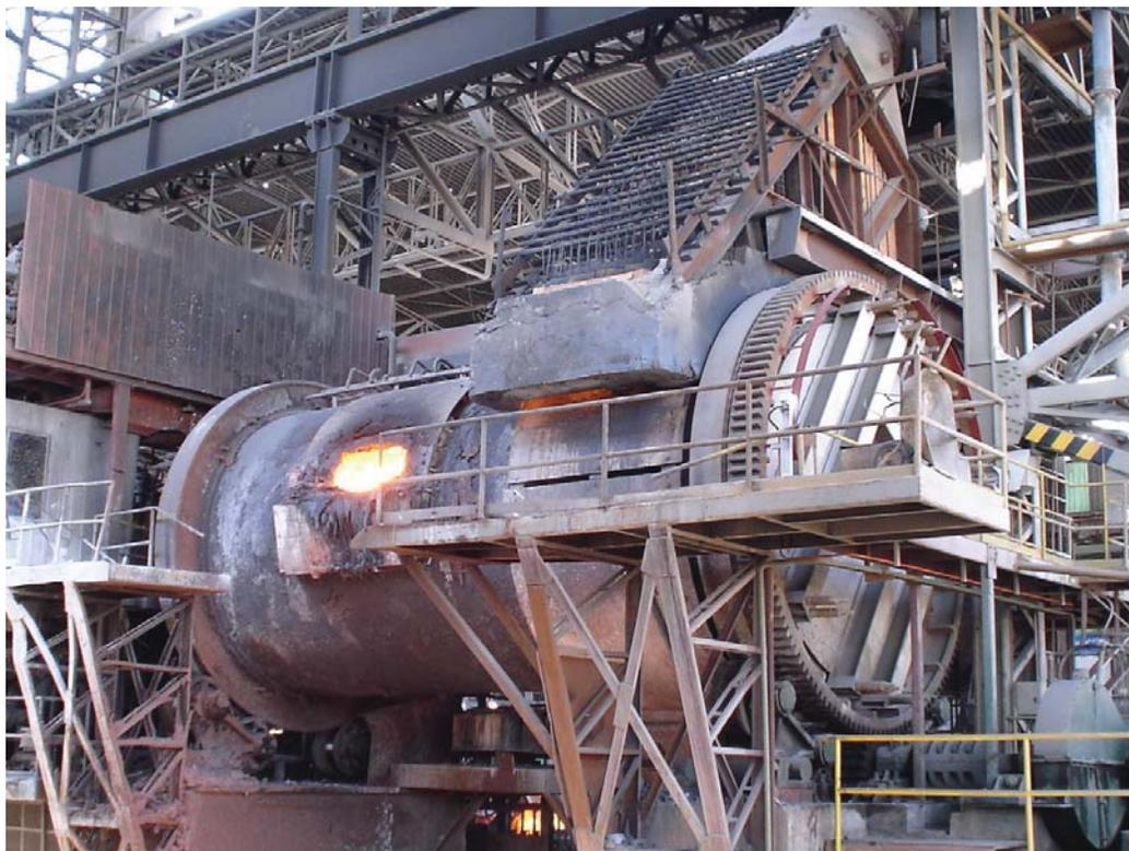
**Figura N° 14: Horno Refinación Anódica, Fundición Caletones.**
