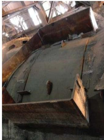
**Figura N° 41: Parche en Boca de Gases.**
