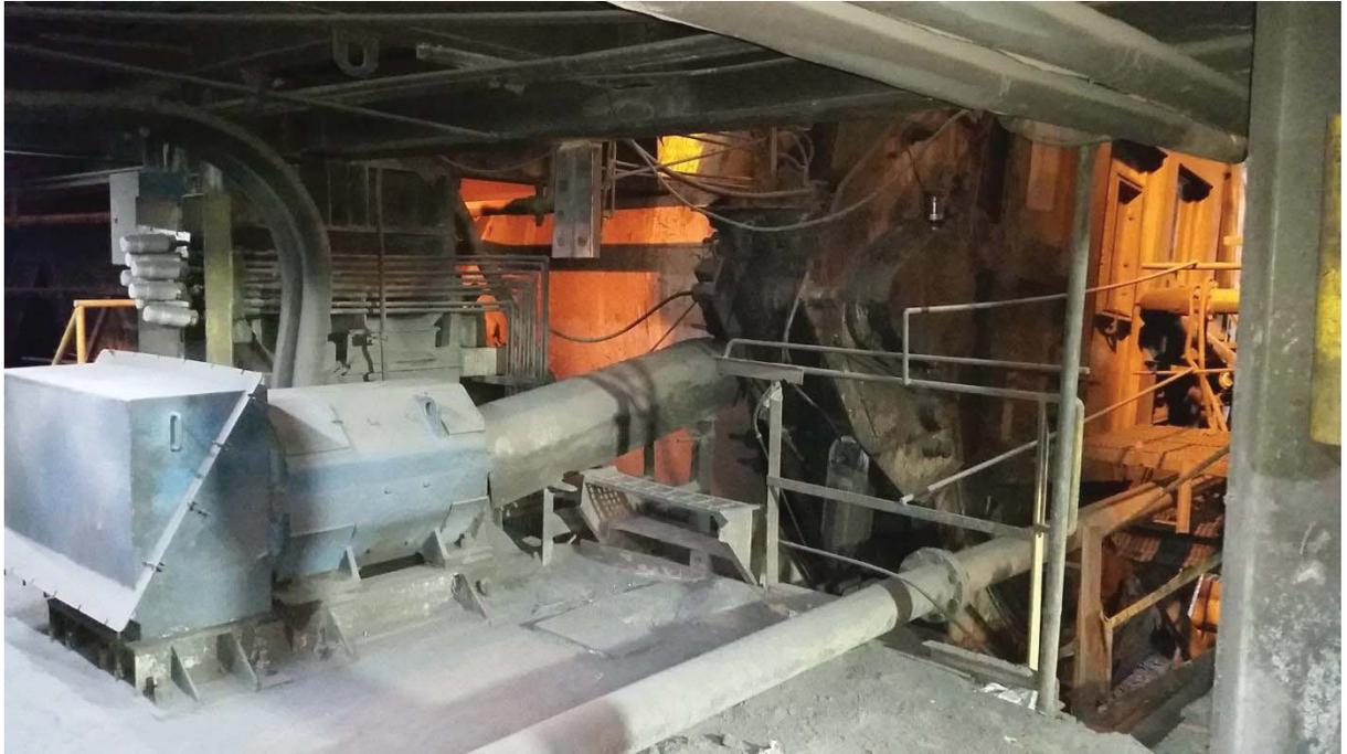
**Figura N° 20: Sistema de giro Bogiflex.**
