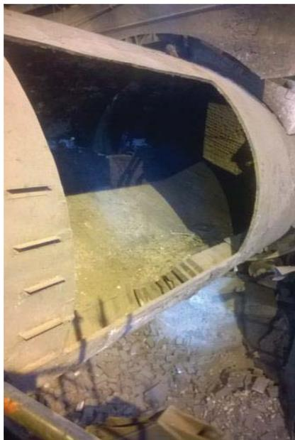
**Figura N° 31: Corte en Casco Horno HREA.**
