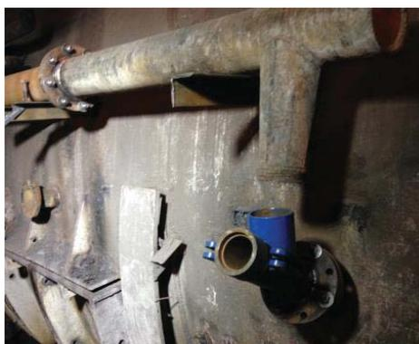
**Figura N° 47: Toberas de inyección de carboncillo.**
