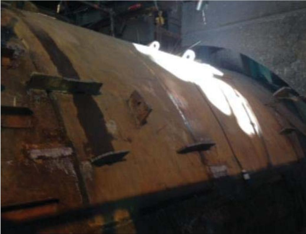
**Figura N° 30: Parche Montado en Casco.**
