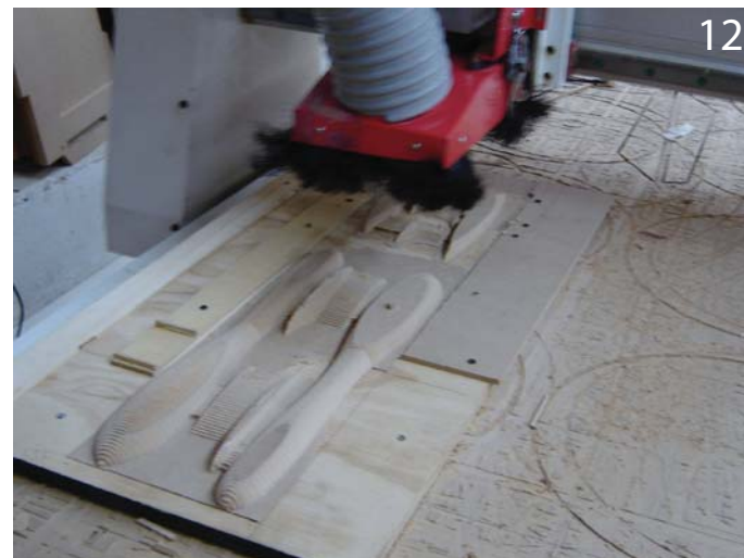
Figura 419. Fotografías de la secuencia de desbaste del bloque. Fuente: Elaboración propia
