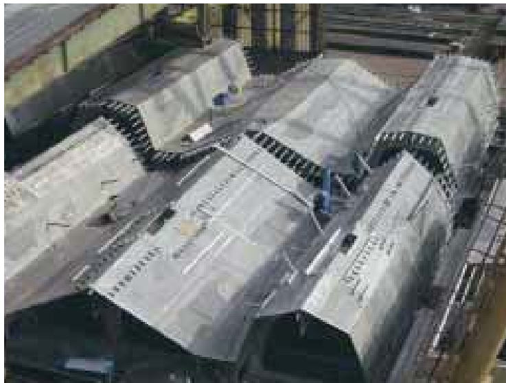
Figura 331. Ensamble de los bloques del casco superior del Aliswath. Fuente: Dagradi, 2006. L'ali-traghetto. Revista Focus. Disponible en: http://www.focus.it/Allega
