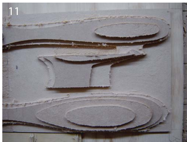
Figura 420. Se desbasta el bloque primero con el desbaste horizontal, formándose 5 capas o niveles escalonados, luego se hace un corte paralelo. Fuente: Elaboración propia
