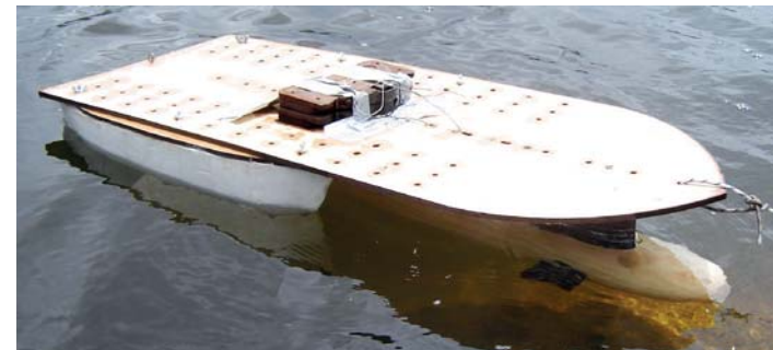
Figura 456. Fotografía del modelo detenido. Se observa que el nivel del agua se encuentra en los arbotantes. Fuente: Elaboración propia.
