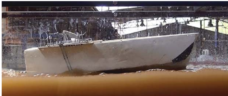
Figura 511. Imagen del modelo en el canal de flujo. Se observa que no se levanta lo suficiente.
