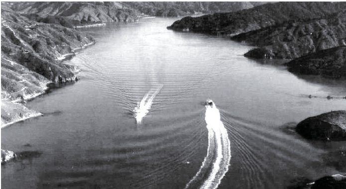
Figura 233. Embarcaciones navegando en régimen subcrítico (izquierdo) y supercrítico (derecha) Fuente: Alaez, 1991. Catamaranes de Alta Velocidad, Publicación num. 130, Madrid, España
