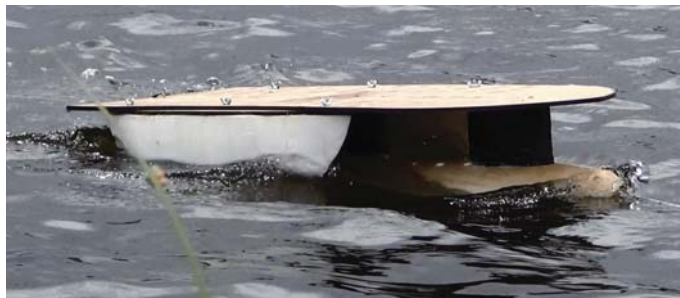
Figura 460. Imágenes del modelo siendo arrastrado. Se observa que la proa del bulbo emerge. Se observa una ola en el casco lateral. Fuente: Elaboración propia.
