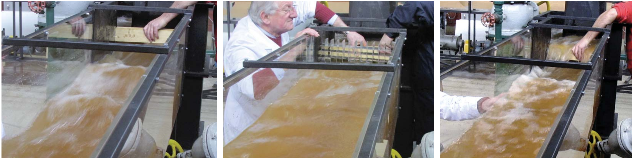
Figura 355. Imágenes de intentos para ordenar el flujo a través de rejilla y un listón de madera
