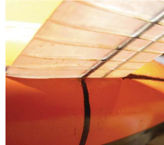
Figura 487. Imagen de la “grilla” que se marca en el bulbo y en las alas. Se trata de líneas de color negro. Fuente: Elaboración propia
