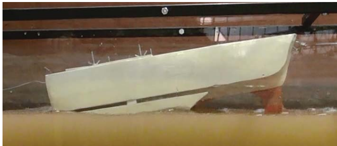
Figura 478. Imagen del modelo con la proa elevada y los cascos laterales más abajo.
