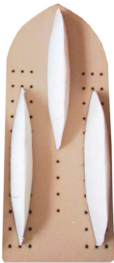
Figura 378. Fotografía del modelo 3D del casco Trimarán de cascos finos ya construido. Fuente: Elaboración propia
