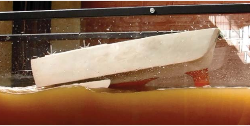
Figura 489. Se mantiene muy estable con los cascos laterales en contacto con el agua.
