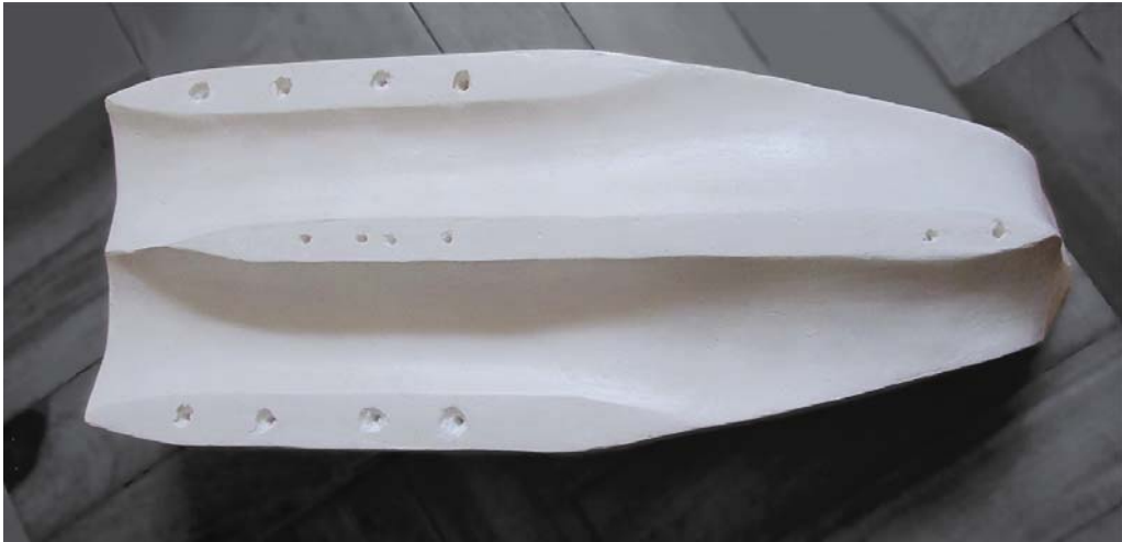
Figura 437. Fotografía de la pieza del casco terminado, pulido y sellado. Fuente: Elaboración propia.
