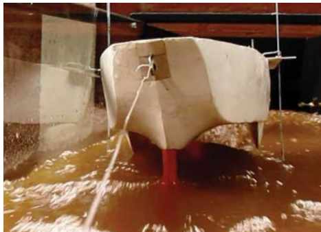
Figura 497. Se elimina la ola del arbotante de papa.
