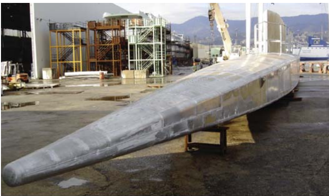
Figura 333. Vista exterior del torpedo y su arbotante. Fuente: Boote y Mascia. Structural Design of Innovative Passenger Vessel. Departamento de Ingeniería Naval y Tecnología Marina de la Universidad de Génova, Italia. Disponible en: http://www.icmrt07.unina.it/Proceedings/Papers/B/04.pdf
