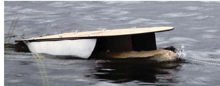
Figura 462. Imágenes del modelo siendo arrastrado. Se observa que, al aumentar la velocidad, casi toda la mitad superior del bulbo emerge. No se forma la ola del casco lateral. Fuente: Elaboración propia.
