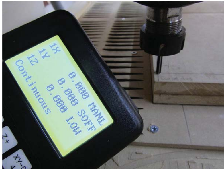
Figura 418. Se ubica la fresa en el punto 0,0, a través del controlador de la Router. Fuente: Elaboración propia
