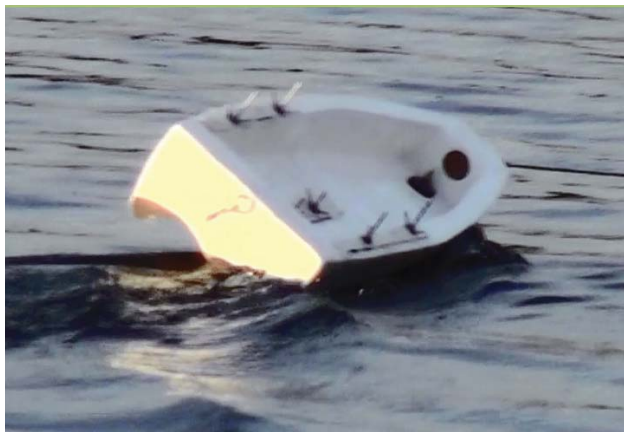
Figura 467. Imagen del modelo siendo arrastrado suavemente. Se escora y se mantiene escorado. Hay problemas de estabilidad estática. Fuente: Elaboración propia
