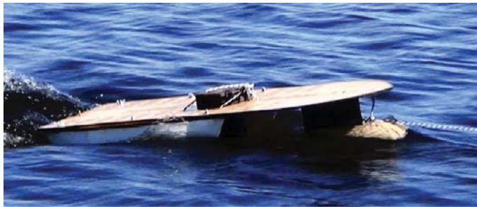
Figura 465. Modelo navegando. Se utiliza configuración segunda y se agrega peso de 1,8 kg y se mueve la toma de la lienza. Fuente: Propia.
