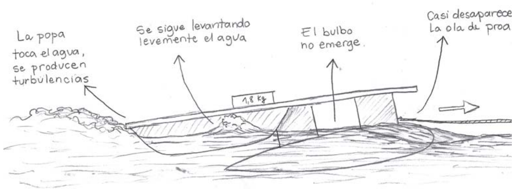
Figura 466. Dibujo del comportamiento del agua mientras el modelo es arrastrado. Se le agregó 1, 8 kg y se mueve la toma de la lienza. Fuente: Elaboración propia
