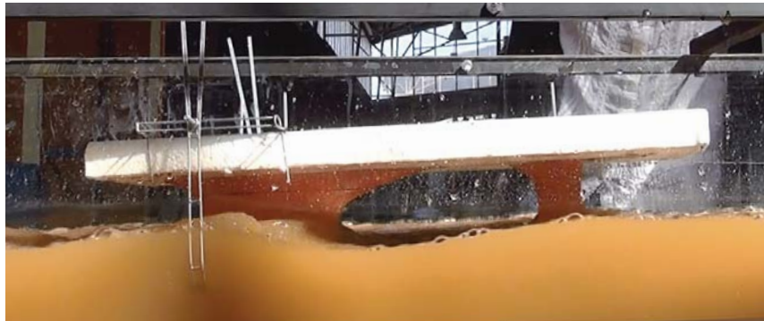
Figura 502. Modelo sin el casco superior. Éste se reemplaza por una plancha muy liviana de plumavit. Además se agregan pesos al bulbo. Todo esto para bajar el centro de gravedad.
