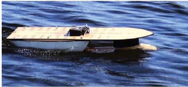
Figura 463. Modelo navegando. Se utiliza configuración segunda y se agrega peso de 1,8 kg. Fuente: Propia.
