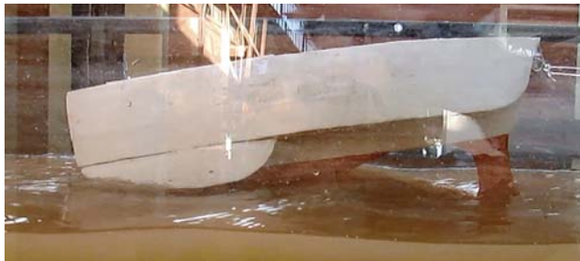
Figura 480. Imagen del modelo en el canal. Se observa que la nave gana sustentación, pero se mantiene la inestabilidad dinámica cuando se eleva.
