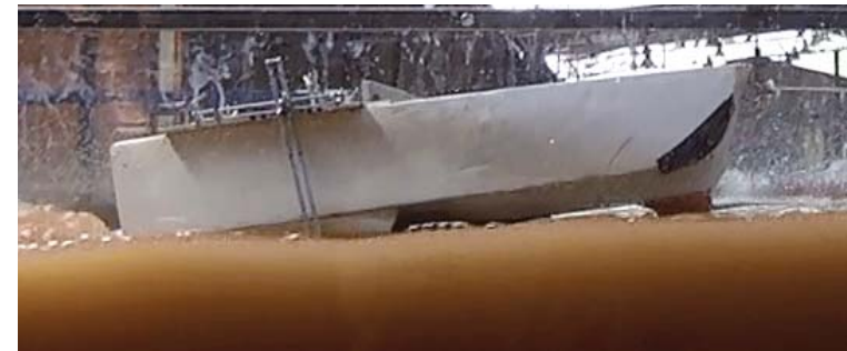
Figura 512. Imagen del modelo en el canal de flujo. Se observa que se levanta levemente. Es muy estable.
