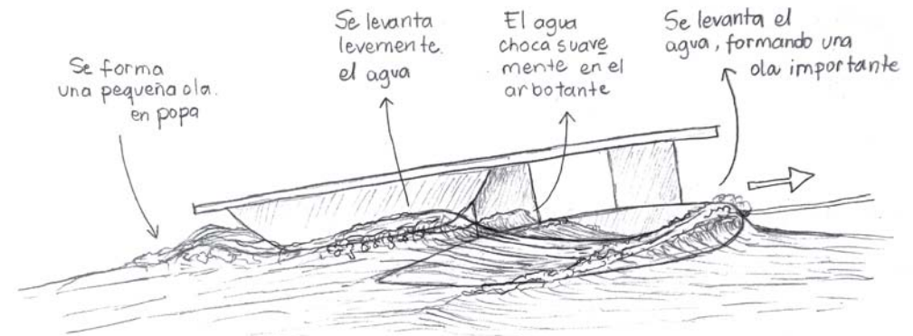
Figura 461. Dibujo del comportamiento del agua mientras el modelo Hyswas primero es arrastrado. Fuente: Elaboración propia
