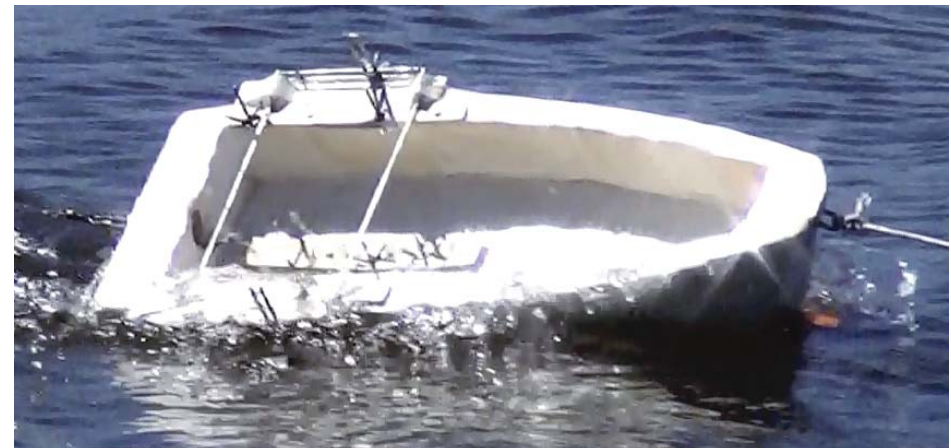
Figura 503. Modelo en movimiento, se escora y se queda así hasta que disminuye su velocidad.
