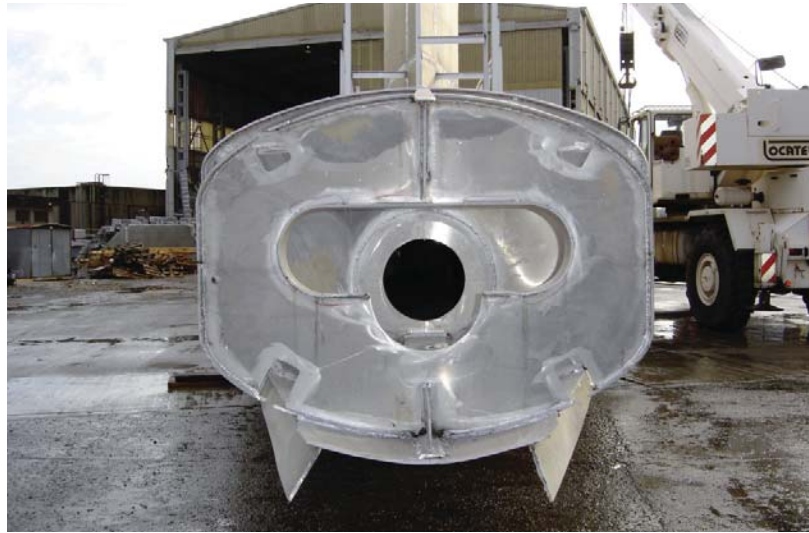
Figura 334. Vista del agujero de salida de la línea de eje de la propulsión en la popa del torpedero. Fuente: Boote y Mascia. Structural Design of Innovative Passenger Vessel. Departamento de Ingeniería Naval y Tecnología Marina de la Universidad de Génova, Italia. Disponible en: http://www.icmrt07.unina.it/Proceedings/Papers/B/04.pdf
