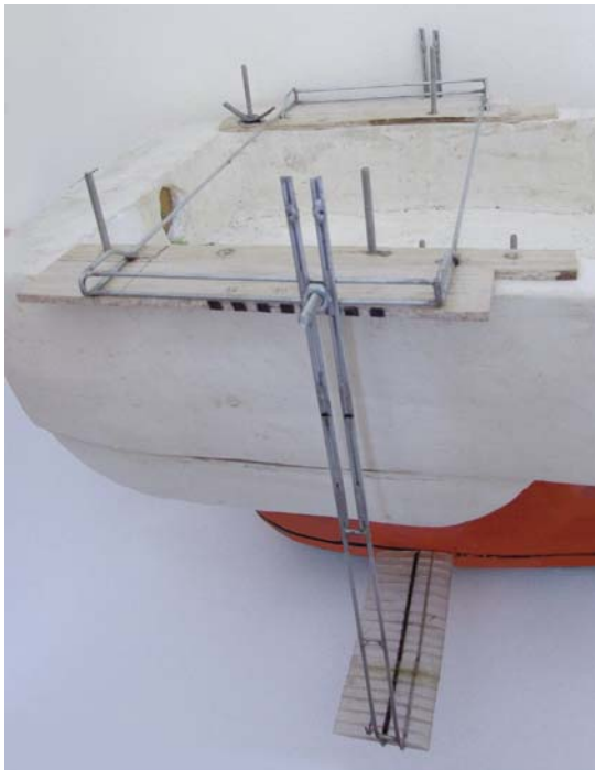
Figura 491. Sistema de fijación del ángulo de las hidroalas.
