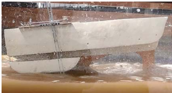
Figura 499. El agua se adecúa a la forma del arbotante de popa y éste la corta. No se produce la ola en este sector.
