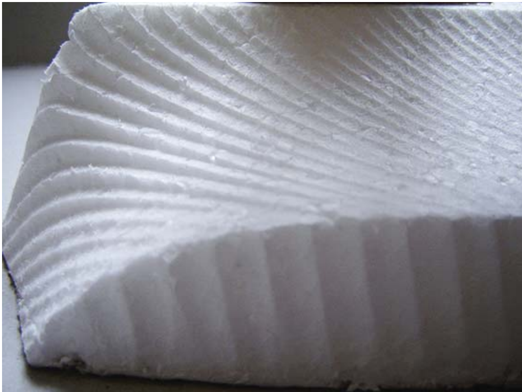
Figura 434. Fotografía de detalle de la superficie del casco hecho de poliestireno expandido de alta densidad. Fuente: Elaboración propia.
