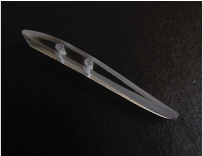
Figura 441. Imagen del perfil y sus dos orificios para incrustar los alambres. Fuente: Propia.
