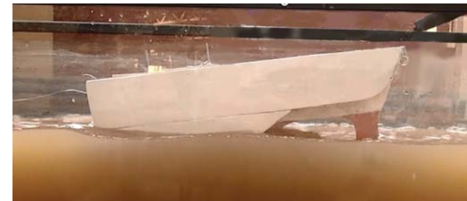
Figura 477. Imagen del modelo con la proa elevada, mientras el agua fluye.
