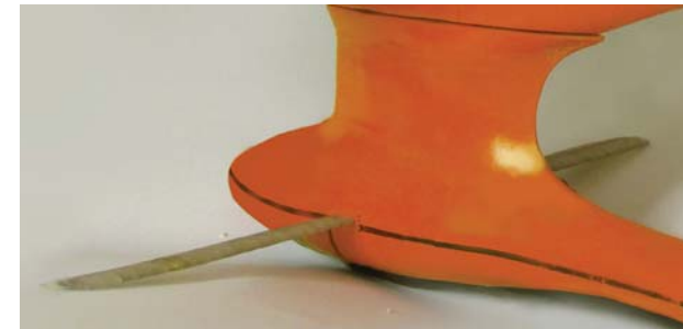
Figura 493. Se agudiza el arbotante de popa, para que éste corte el agua mientras navega.
