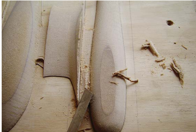
Figura 423. Fotografía de las piezas lijadas y de la extracción de los puentes. Fuente: Elaboración propia
