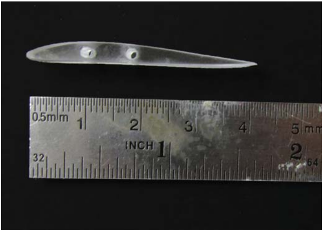
Figura 440. Imagen del perfil ya cortado en la máquina láser. Fuente: Propia.
