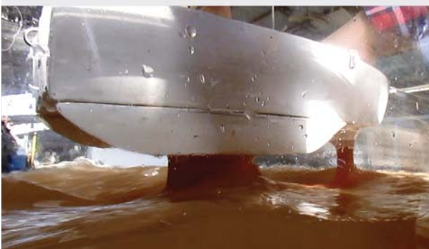
Figura 481. Se observa la formación de olas en los arbotantes.
