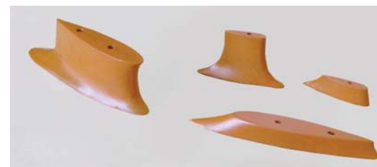
Figura 410. Imágenes del modelo, bulbo armándose por parte. Fuente: Propia
