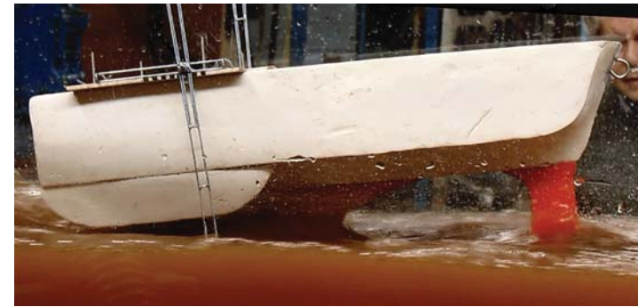
Figura 495. Cuando se despegan los cascos laterales, pierde estabilidad. En esta imagen, el modelo está apoyado a la pared del canal y se mantiene estable.
