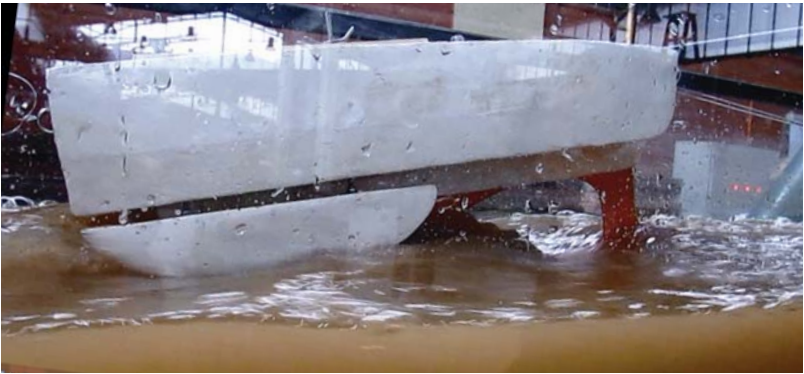
Figura 490. Se produce igualmente el choque del agua en el arbotante de popa.
