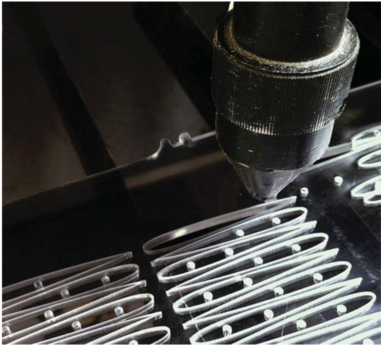
Figura 439. Proceso de corte de los perfiles alares en la máquina láser CNC. Fuente: Elaboración propia.
