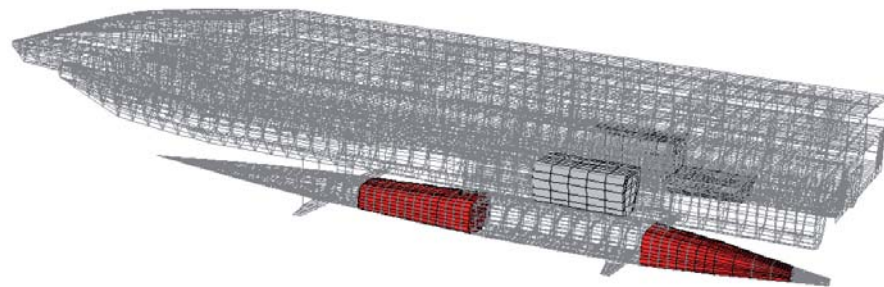
Figura 325. Condición de Hull Borne: Los lastres del casco sumergido están cargados. Fuente: Boote y Mascia. Structural Design of Innovative Passenger Vessel. Departamento de Ingeniería Naval y Tecnología Marina de la Universidad de Génova, Italia. Disponible en: http://www.icmr07.unina.it/Proceedings/Papers/B/04.pdf
