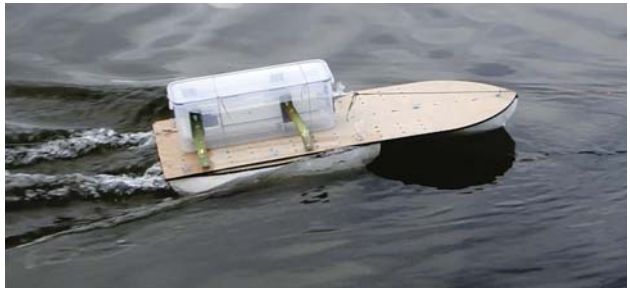
Figura 451. Fotografía del modelo siendo arrastrado. Se observa la ola en el lado exterior del casco lateral.
