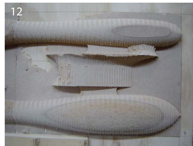
Figura 420. Se desbasta el bloque primero con el desbaste horizontal, formándose 5 capas o niveles escalonados, luego se hace un corte paralelo. Fuente: Elaboración propia
