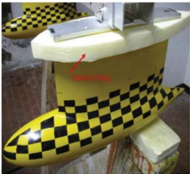
Figura 301. Fotografía del casco construido listo para ser probado en el canal hidrodinámico. Fuente: Brizzolara y Villa, 2009. Hydrodynamic Assessment and Optimization of Slice Hull Forms. Italia, University of Genova – Dept. of Naval Architecture and Marine Engineering, DINAV.
