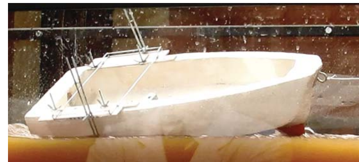
Figura 496. Cuando se eleva, pierde estabilidad, escorándose de lado a lado, ya que tiende a recuperarse exageradamente después de cada escora.
