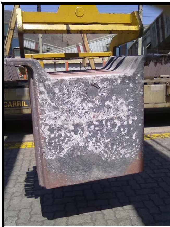
Fig. N°40. Ánodo rechazado por impregnación de desmoldante.
