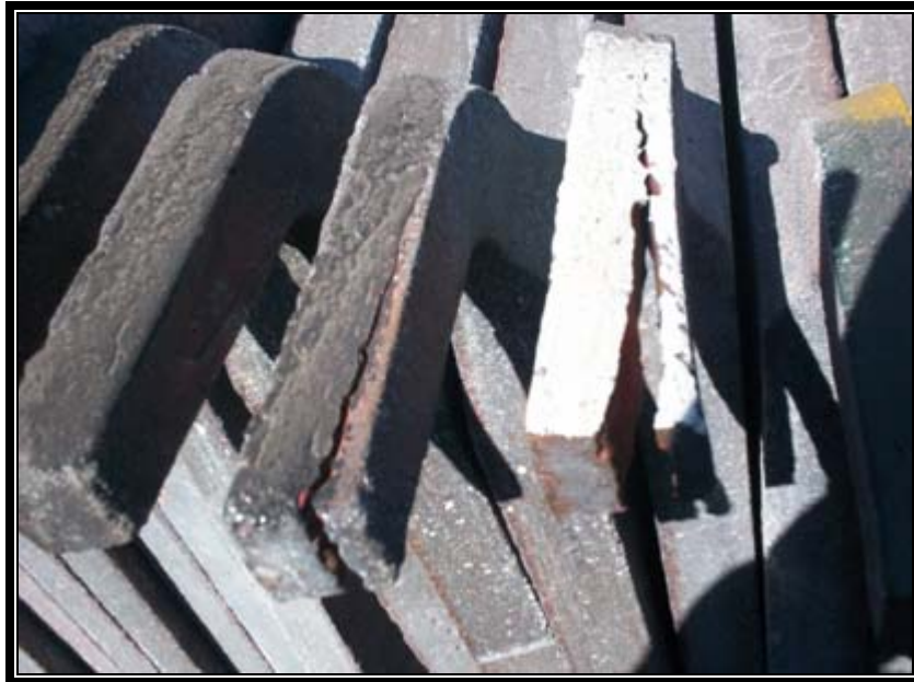
Fig. N°33. Ilustración de la doble capa donde se aprecia la doble solidificación y las orejas abiertas.
