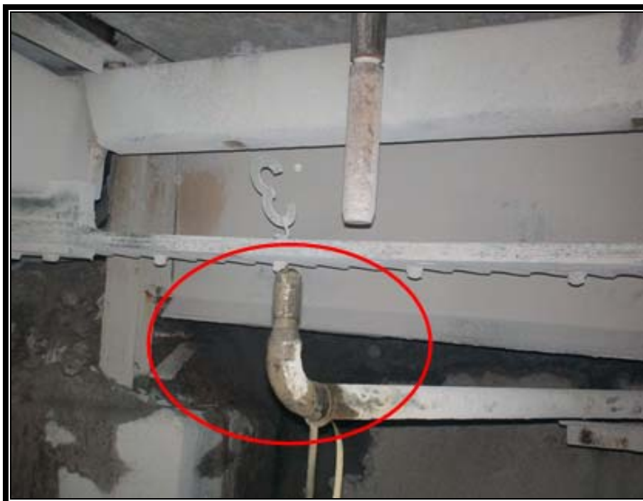
Fig. N°10. Dispersor del agua de refrigeración en la posición número 3 de la rueda de moldeo.
