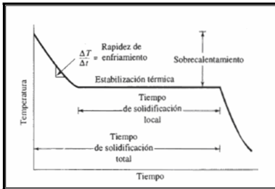
Fig. Nº22. Curva de enfriamiento para la solidificación de un metal.
