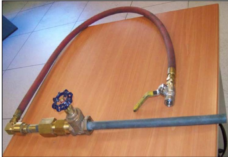
Figura 63: Inyector de una columna de flotación.
