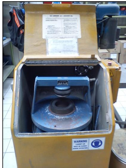
Figura A-5: Pulverizador.
