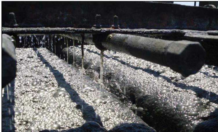
Figura 56: Obstrucción del agua de lavado en una columna de flotación.
