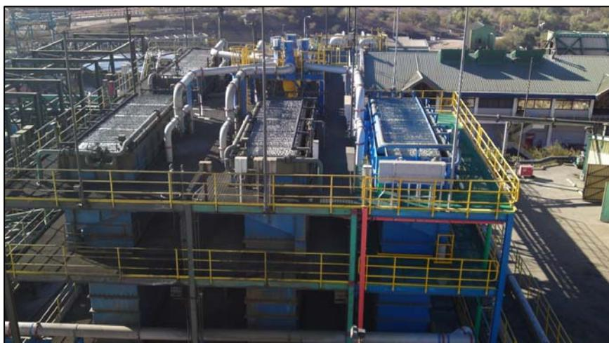
Figura 37: Vista desde arriba de columnas de flotación Las Tórtolas.
