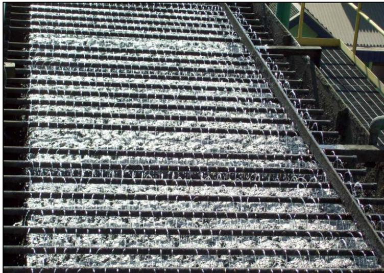
Figura 57: Distribución del agua de lavado en una columna de flotación.
