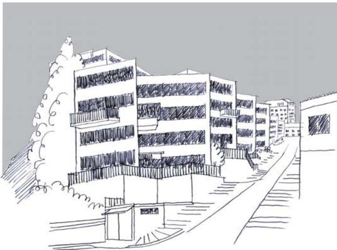
Cr 66 bloques que abordan la ladera aterrasandose y a través de dislocaciones logra una disposición de su volumen en función de la luz. la parte varía según la altura que va tomando a medida que aborda la ladera.
