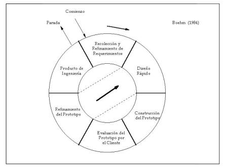
Figura. 6.2: Modelo prototipo
