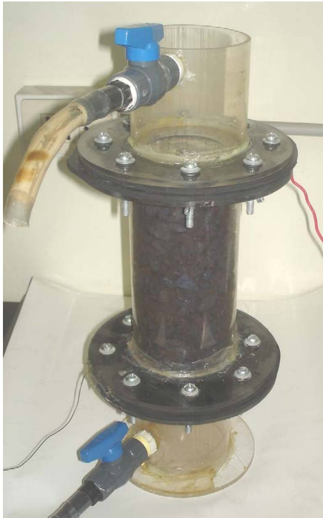
Figura 7.14. Reactor Electroquímico Ensamblado con semiconductor en su interior.
