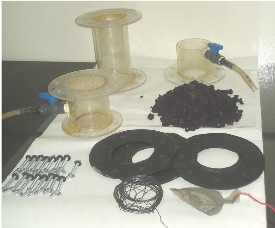
Figura 7.11. Piezas del reactor electroquímico antes de su ensamblaje.
