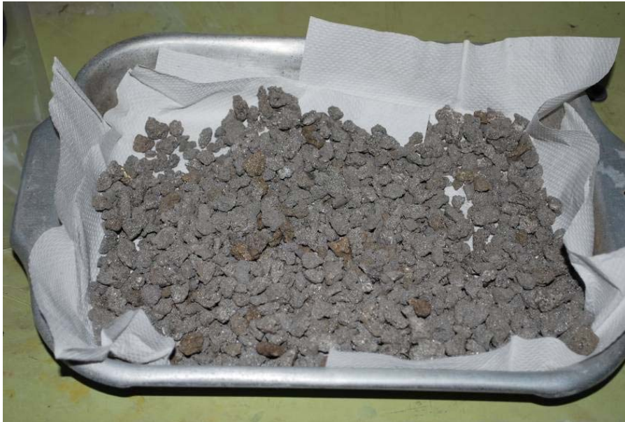
Figura 7.2. Esponjas de Titanio antes de dopar de diámetro entre 2-12 mm
