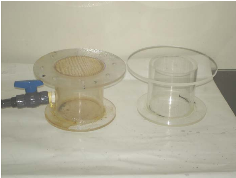
Figura 7.8. Vista frontal de la sección anódica.
