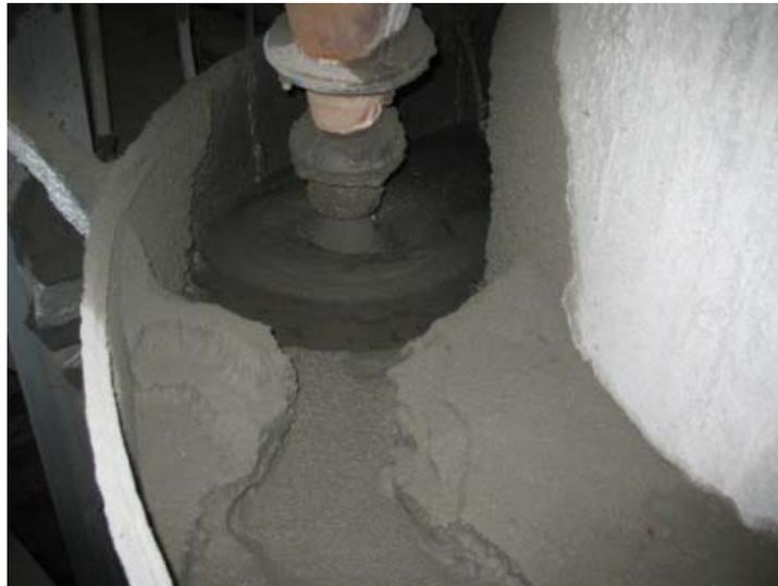
**Figura 5.12. Acordonamiento de los Hidrociclones**
