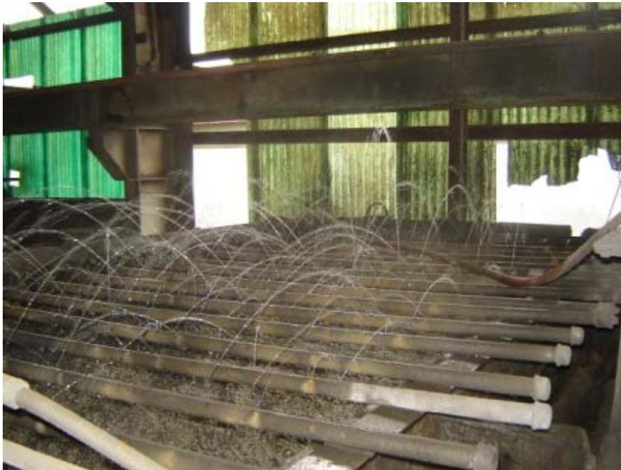
**Figura 5.3. Sistema de Adición de Agua Columna 2**
