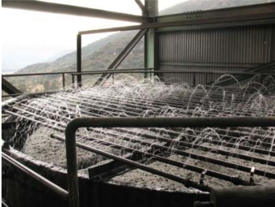
El principal problema del sistema de adición de agua es que la red de agua posee una alta cantidad de impurezas las cuales regularmente obstruyen los orificios de las barras y la manipulación inadecuada de las válvulas de control produce flujos irregulares y hacen ineficiente el sistema, como se aprecia en la figuras 5.2 y 5.3.
