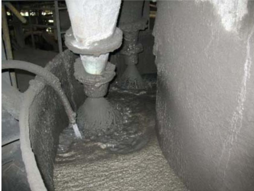
Esta adición se realiza mediante tres mangueras de la red de incendio, pero esta adición no cuenta con ninguna medición de flujo con lo que además de hacer fluir la pulpa, se podría estar afectando directamente el proceso de molienda.
