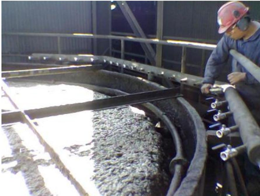
Como segunda medida, el control del flujo de agua se automatizó, así el flujo se mantiene constante y se evita la manipulación en terreno, ver figura 5.6.
