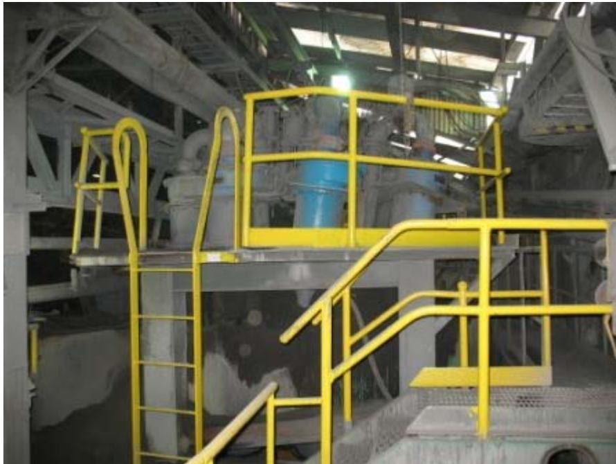
Debido a un problema de diseño en el launder del underflow la pulpa no escurre fácilmente hacia el cajón de alimentación de los molinos. Debido a que la inclinación o pendiente del launder no es la suficiente para que la pulpa se desplace naturalmente hacia el cajón de alimentación de los molinos. Además en la parte
