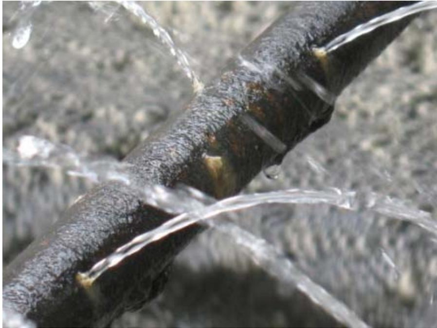
Las lamas obstruyen los orificios alterando la presión en la barra originando una adición irregular de agua a la pulpa. Y con ello, una baja eficiencia en el lavado del concentrado resultante.
